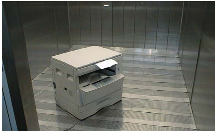
Abbildung K 2: Bild der 20 m³-Emissionsmesskammer, beladen mit einem untersuchten Kopierer
