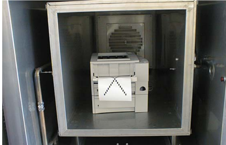
Abbildung K 1: Bild der 1 m³-Emissionsmesskammer Typ B, beladen mit einem untersuchten Drucker
