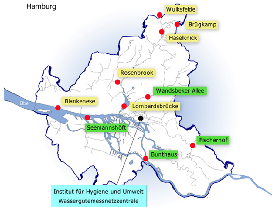
Abbildung 28 Automatische Messstationen in Hamburg (grün unterlegt – Stationen die zusätzlich ein Biologisches Frühwarnsystem betreiben)
