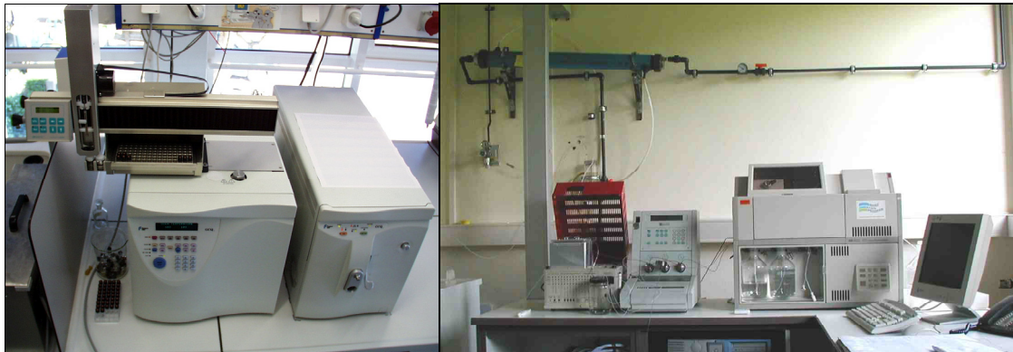
Abbildung 32 li.: GC/MS Rheingütestation Worms, re.: HPLC/DAD Messstation Bimmen
