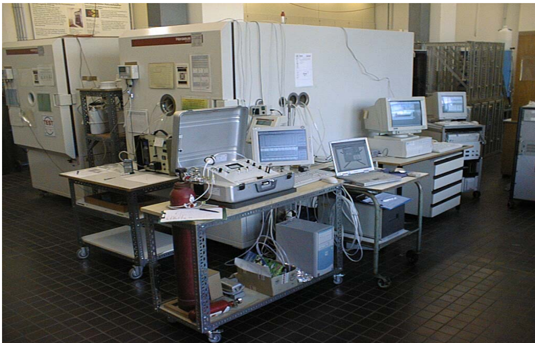
Abbildung 2: 1 m 3 -Emissionsmesskammer, kompletter Messplatz
