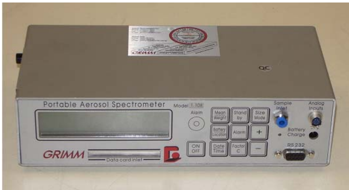
Abbildung 57: Partikelspektrometer Grimm 1.108 Portable Aerosol Spectrometer
