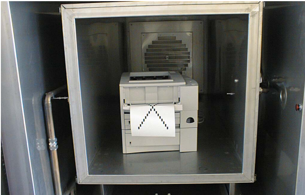
Abbildung 1: 1 m 3 -Emissionsmesskammer, beladen mit einem Drucker
