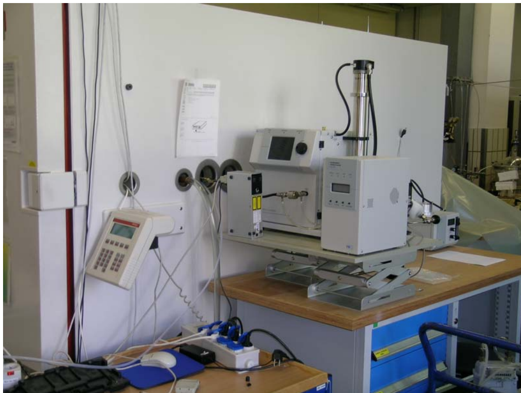
Abbildung 59: Anordnung der Partikelspektrometer an der 1 m 3 Testkammer
