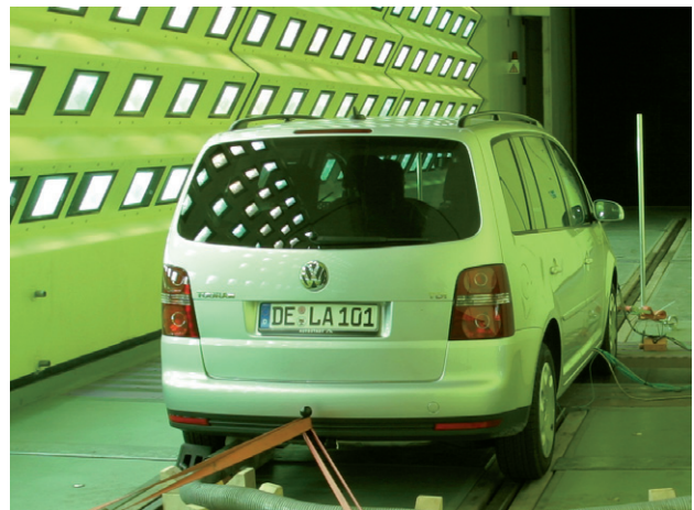
Messungen im Klima-Wind-Kanal
