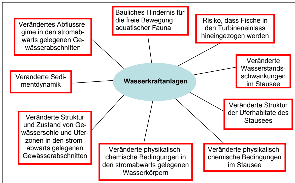
Abb. 4a: Veranschaulichung des Spektrums möglicher Veränderungen, die mit Wasserkraftanlagen und den in der Folge eintretenden biologischen Veränderungen in der Regel verbunden sind (weitere Informationen dazu in Anhang III).
