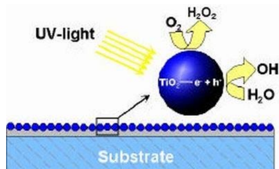
Abbildung 2-3: Das Prinzip der Photokatalyse an \text{TiO}_2
