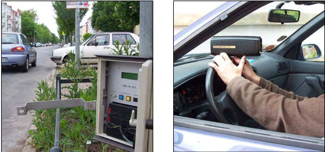
Abb. 9: Impaktor-Messgerät für Geschwindigkeit und Kfz-Mengen (links, geöffnet) und Radarpistole (rechts)
