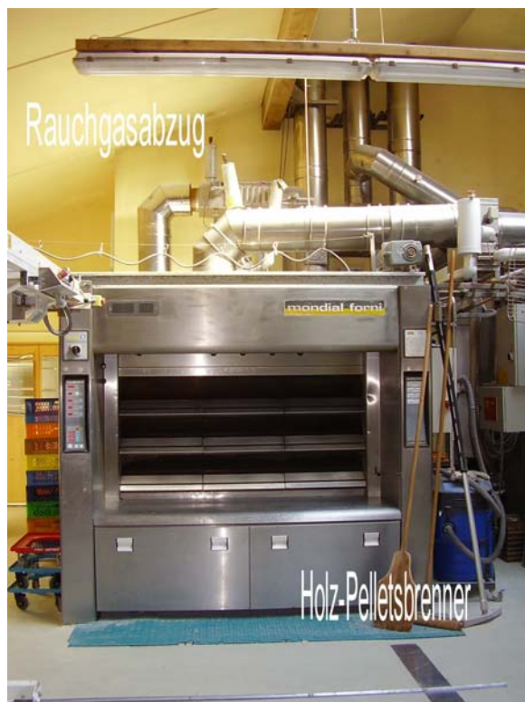
Abb. 5 Etagenbackofen im Betrieb der Bäckerei Schwarzmaier mit Angaben zur Position des Brenners, des Rauch- und Schwadenabzuges
