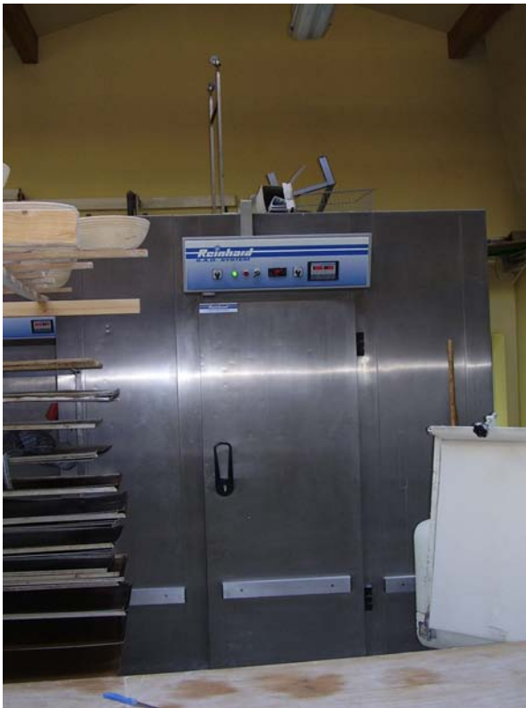
Abb. 13 Großer Gärunterbrecher mit integrierter Kühlzelle
