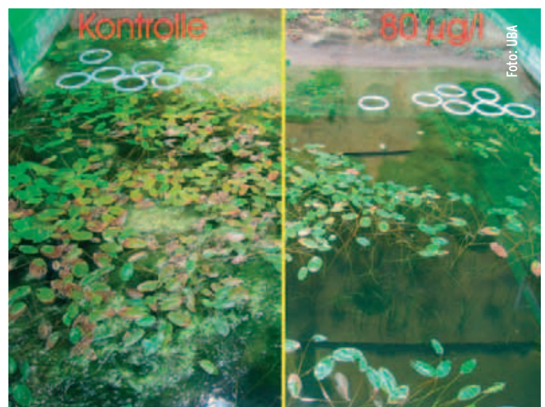
FSA – Versuch zu Auswirkungen eines Herbizids im Wasser. Wasser links ohne, rechts mit Herbizidwirkstoff (80 µg Metazachlor pro Liter).
