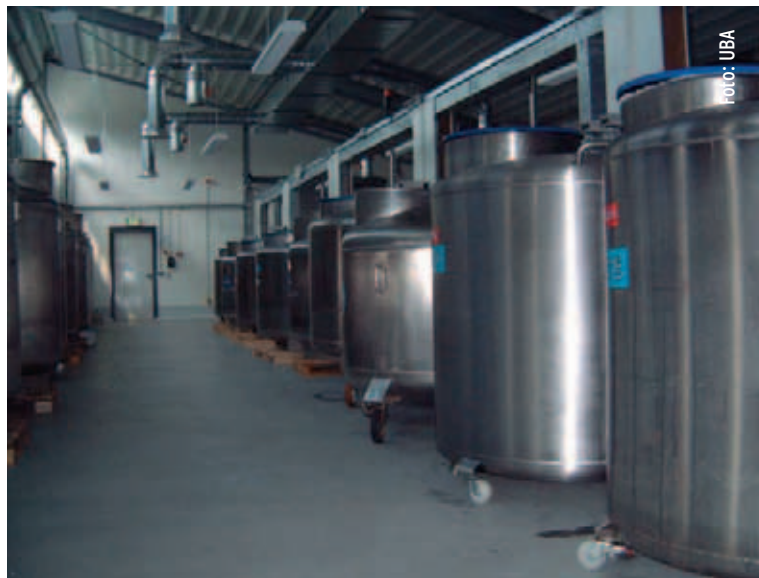
Proben der Umweltprobenbank werden bei – 150 °C veränderungsfrei in Kryo-Behältern gelagert.
