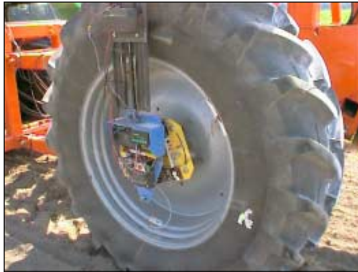
Abbildung 19: Sensorik an der Einzelradmessvorrichtung der FAL zur Ermittlung von Radumdrehung und Reifenverformung.
