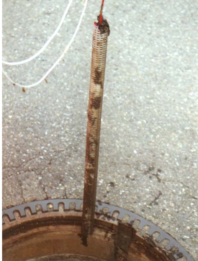
Abbildung 25: SAF-Körper nach der Entnahme aus dem Kanalnetz
