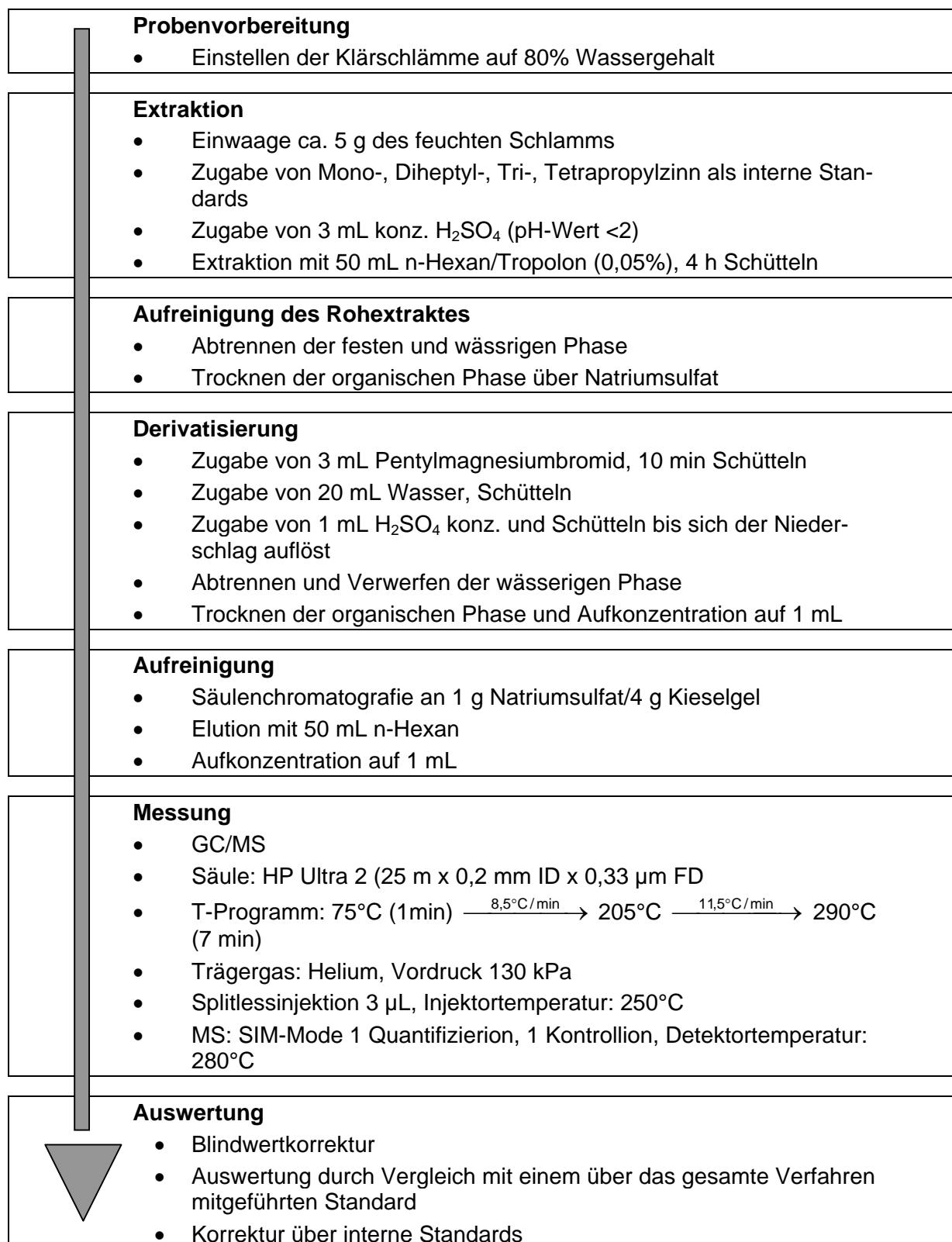
Abbildung 3: Analysenschema zur Bestimmung von organischen Zinnverbindungen in Klärschlämmen - in Anlehnung an DIN 38407-13
