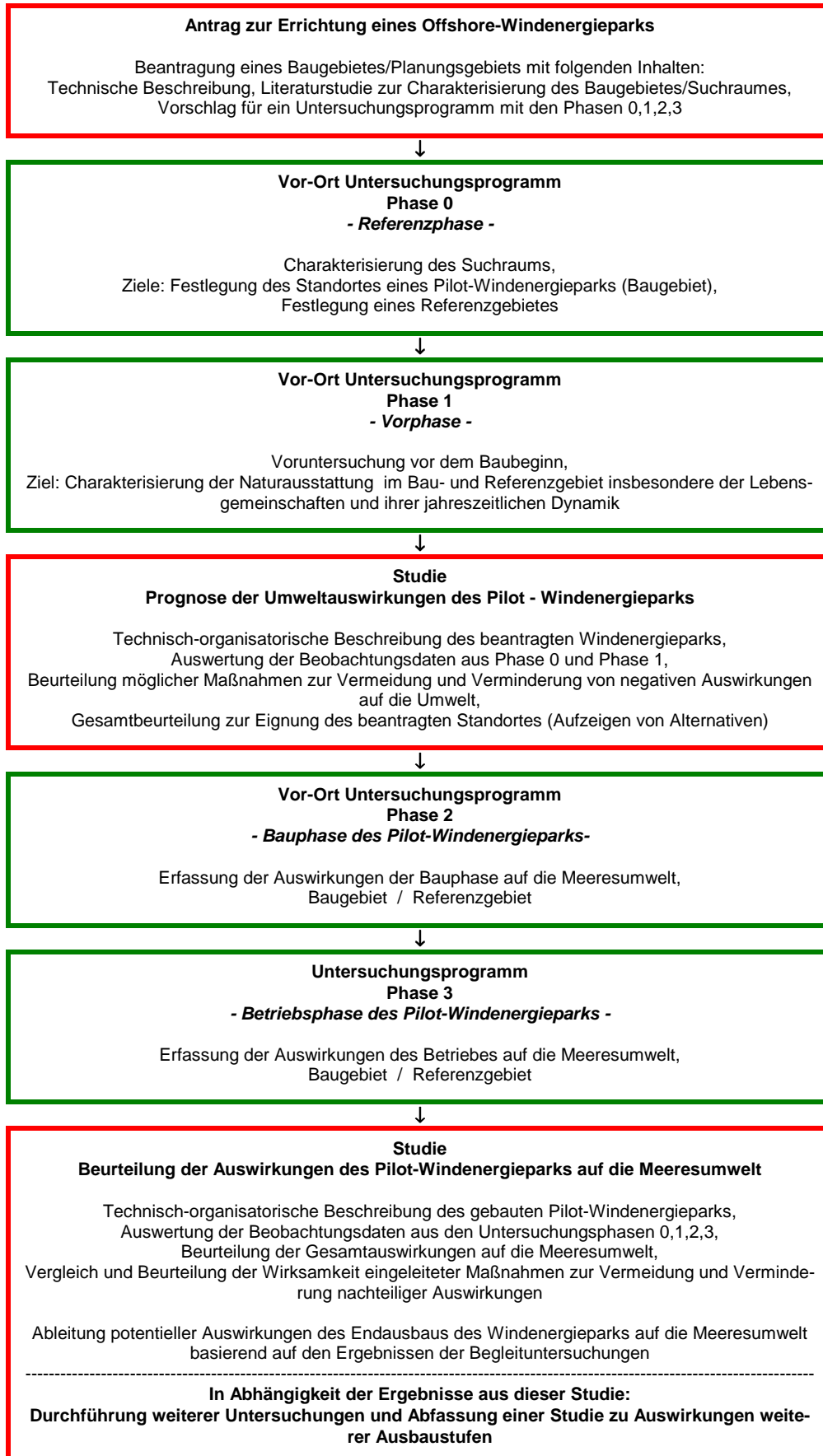
Abb.1: Ablaufschema zur Durchführung und Auswertung von Untersuchungen zum Bau und Betrieb von Offshore-Windenergieparks
