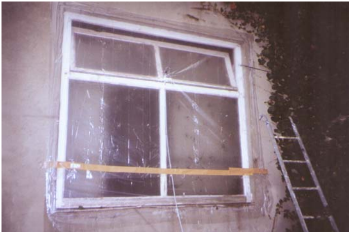
Abb. 35: Abgedichtetes Fenster während des Versuches 3 in Bingen
