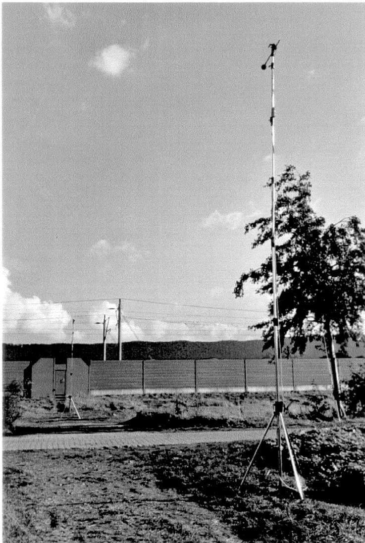
Bild 4 25 m- und 50 m-Mikrofon in der Meßebene der Notfalltür nach Erneuerung der SSW
