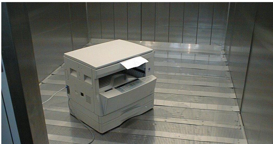
Abbildung 12: Bild der 20 m 3 - Emissionsmesskammer, beladen mit einem untersuchten Kopierer
