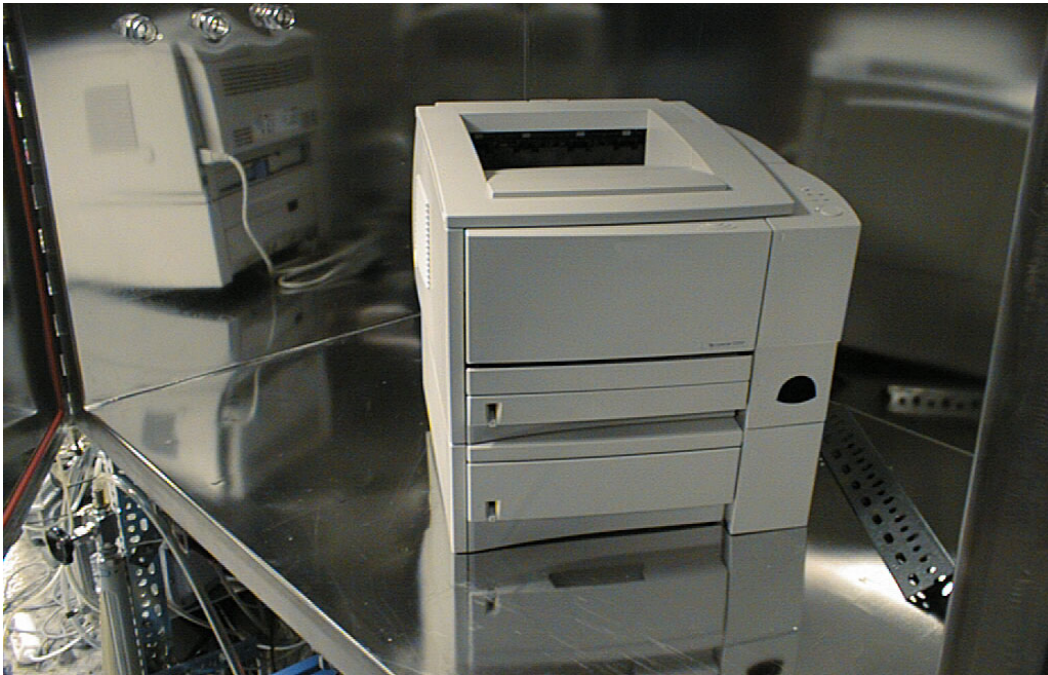
Abbildung 9: Bild der 1 m 3 - Emissionsmesskammer A, beladen mit einem untersuchten Drucker
