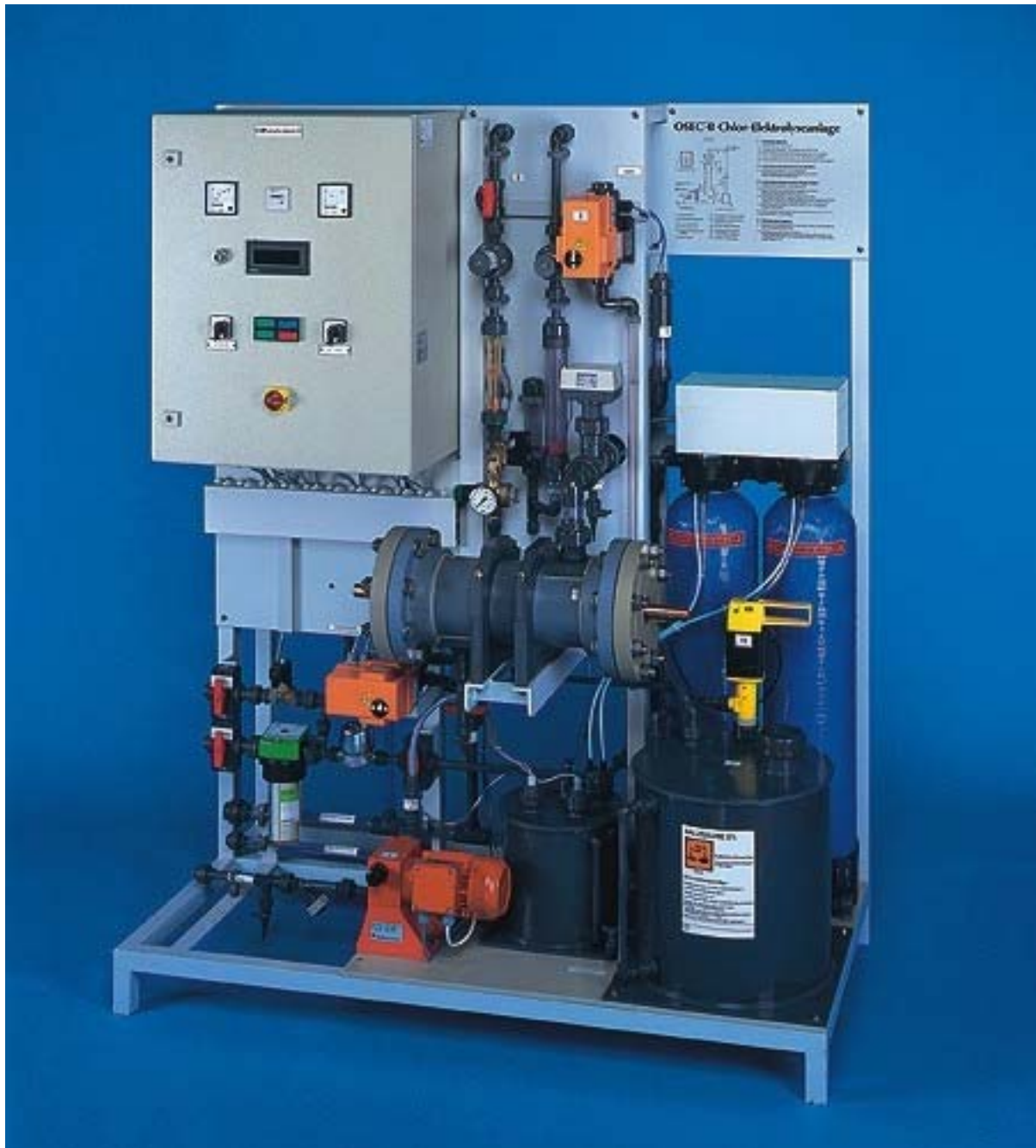
Abbildung 15: Rohrzellen-Elektrolyseanlage mit Wasserenthärter und automatischer Elektroden-Reinigung mit Salzsäure
