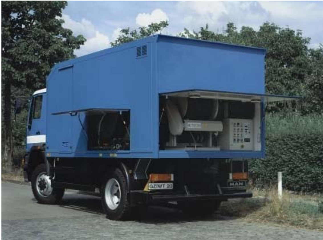
Abbildung 27: Mobile Chlorungsanlage für die Rohrnetzchlorung, eingebaut in einem LKW.
