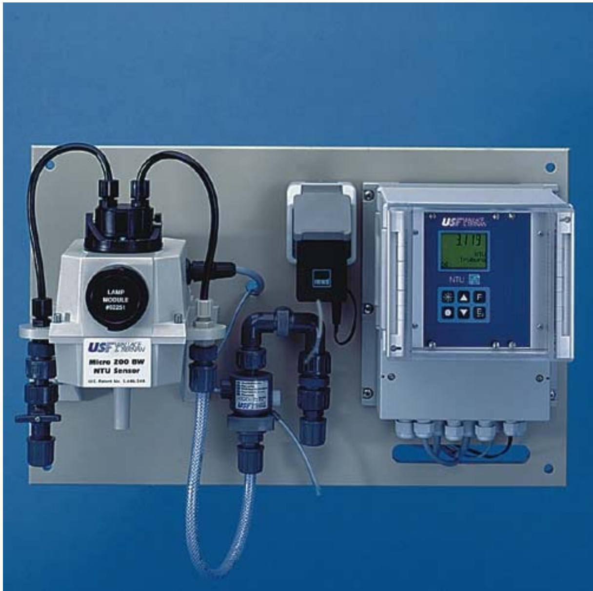
Abbildung 48 Komplette Messanordnung für die Trübungsmessung in Trinkwasser, mit optischer Einheit (links), Verrohrung und elektronischer Auswertung (rechts)
