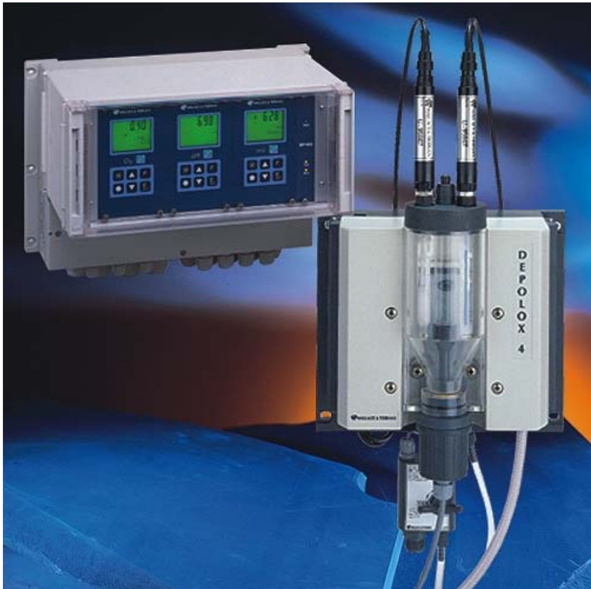
Abbildung 50: Messanlage für freies Chlor, pH-Wert und Redox-Spannung. Die Messung des freien Chlors erfolgt im unteren Teil des Plexiglaskörpers, für die Messung von pH-Wert und Redox-Spannung sind Einstabmessketten eingesetzt, auf denen Impedanzwandler zur störungsfreien Mess-Signal-Übertragung angebracht sind.
