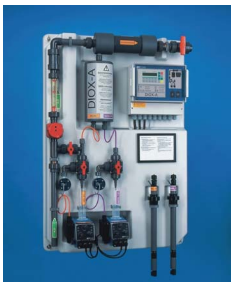
Abbildung 22: Bereitungs- und Dosieranlage für Chlordioxid nach dem Chlorit-/Salzsäure-Verfahren mit verdünnten Lösungen. Diese Anlage ist für kleine Leistung bis 250 g/h Chlordioxid ausgelegt.
