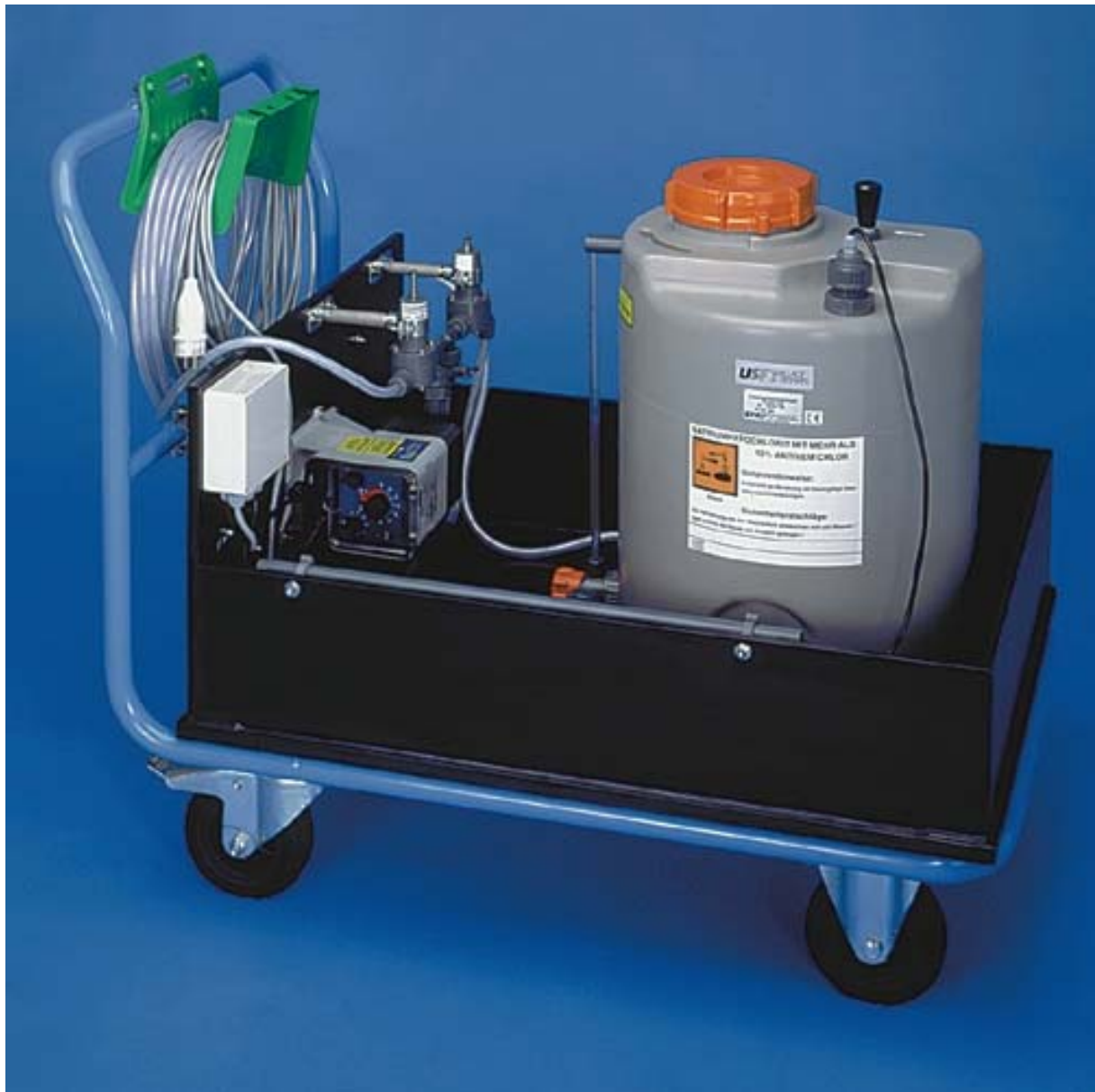
Abbildung 23: Fahrbare Dosieranlage für Chlorklösungen. Die Auffangwanne mit allen Anlagenteilen ist abnehmbar. Die Dosierleistung kann manuell oder automatisch eingestellt und über ein Durchflusssignal gesteuert werden.
