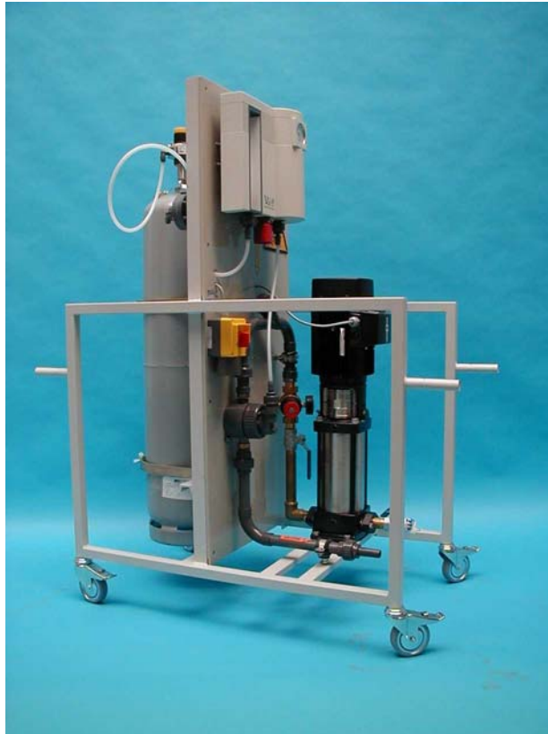
Abbildung 25: Mobile Chlorgasdosieranlage (trag- und fahrbar) mit Druckerhöhungspumpe, Vollvakuum-Chlorgasdosiergerät, Injektor und einer Chlorflasche (Rückseite der Anlage)
