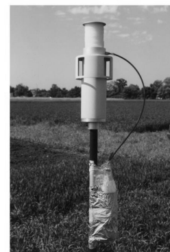
Abb. 4 Pollensammler SIGMA 2 mit Pollenmassenfilter
