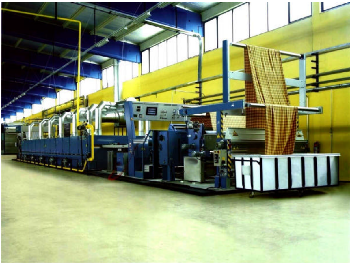
Abbildung 2.13: Moderner Spannrahmen in der Textilveredlungsindustrie
