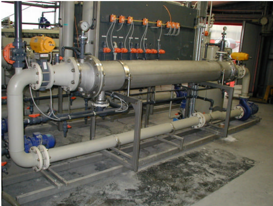
Abbildung 4.55: Mikrofiltrationsanlage zur Behandlung und Recycling von Abwasser aus einer Farbküche zur Zubereitung von Pigmentdruckpasten und von Waschwasser aus einem Wäscher zur Behandlung von Spannrahmenabgas
