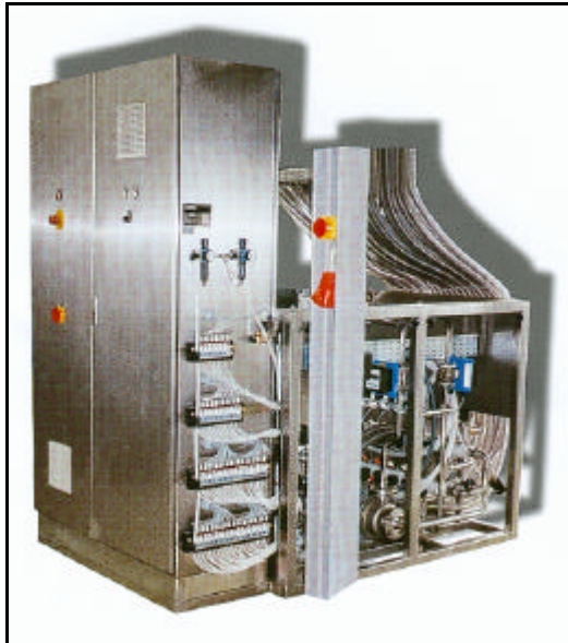
Abbildung 4.4: Beispiel für die on-line-Zubereitung von Klotzflotten für die Ausrüstung von Gewebe und Maschenware (Bilder von Mutschink GmbH, D-47918 Tönisvorst)
