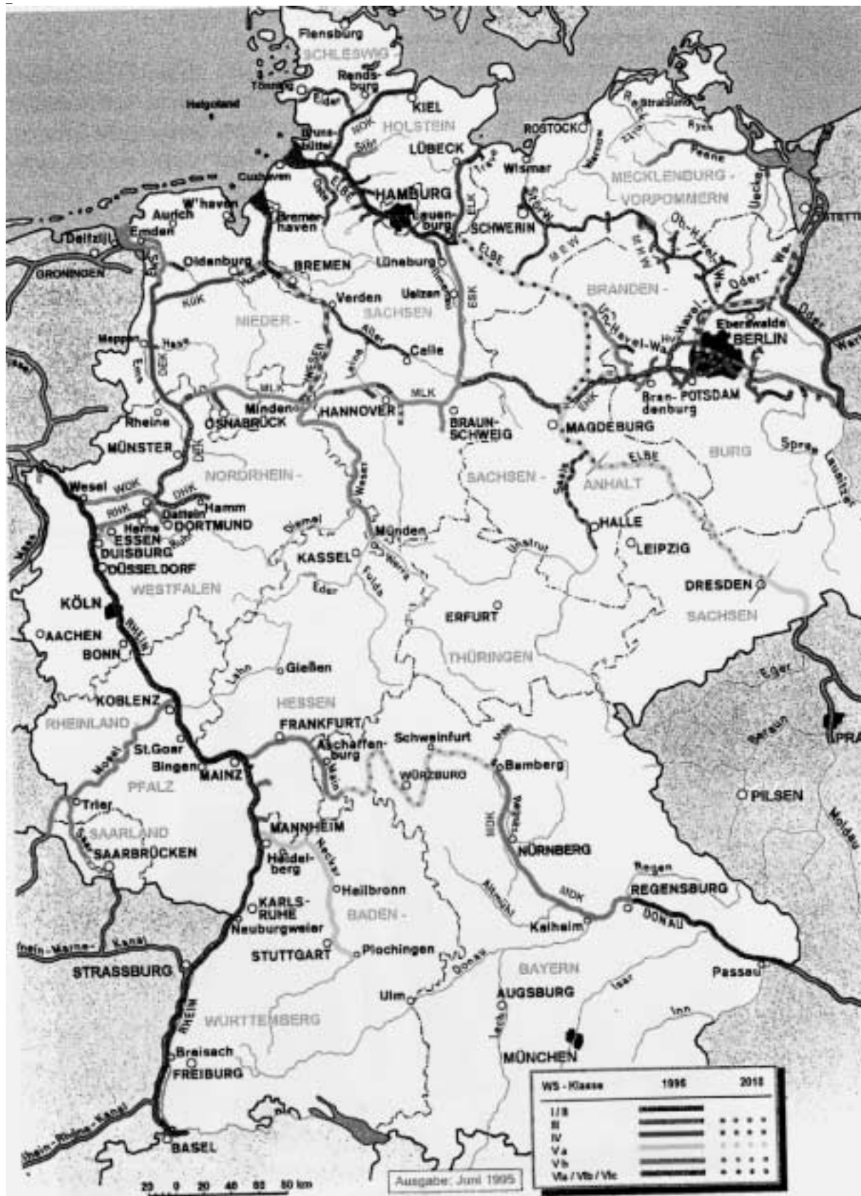
Abb. 14: Wasserstraßenklassen der deutschen Binnenwasserstraßen
