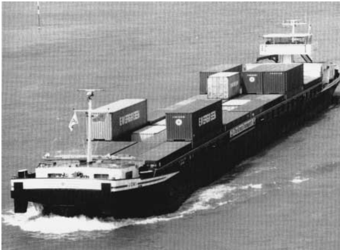
Abb. 39: Container-Motorschiff mit 4-reihiger Containerstauung (Breite ca. 12 m)
