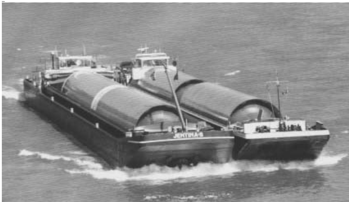
Abb. 32.b: Trocken-Motorgüterschiffe (beladen mit Schwergütern, gekoppelt fahrend)
