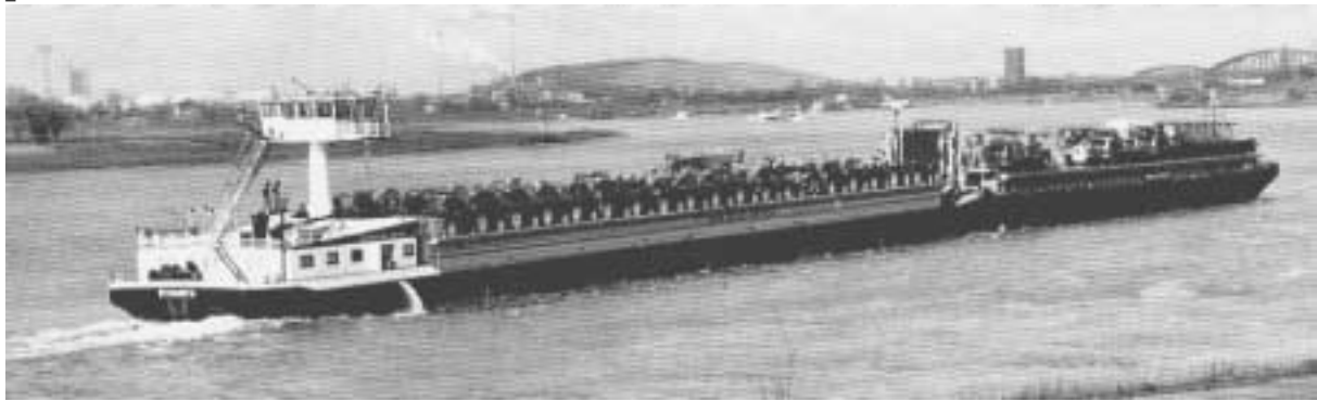
Abb. 38.a: Koppelverband (Ro/Ro-Motorschiff und Ro/Ro-Leichter)
