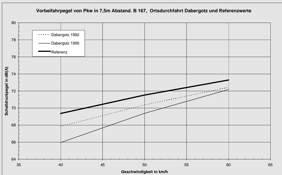
Bild 4.44: Vergleich der Vorbeifahrpegel von Pkw über der Geschwindigkeit bei den Untersuchungen in 1992 und 1995 mit Referenzwerten für eine innerörtliche Asphaltbetonstraße
