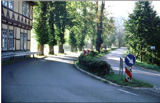
Bild 4.32: Mittelinseln in Kurvenlage bieten die beste Geschwindigkeitsreduzierung
