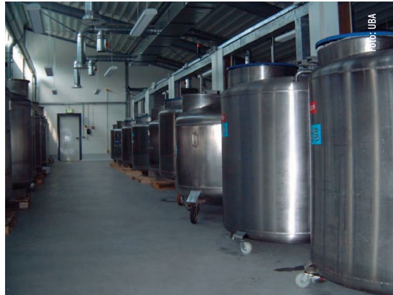
Proben der Umweltprobenbank werden bei – 150 °C veränderungsfrei in Kryo-Behältern gelagert.
