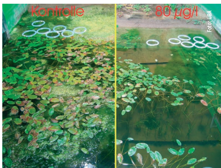
FSA – Versuch zu Auswirkungen eines Herbizids im Wasser. Wasser links ohne, rechts mit Herbizidwirkstoff (80 µg Metazachlor pro Liter).
