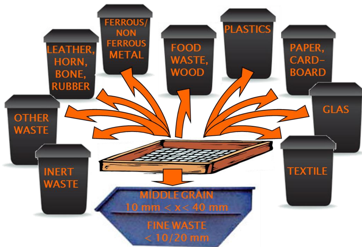
Abb. 3.17: Aufbau und Sortierfraktionen für die Sortierkampagnen in Armenien
