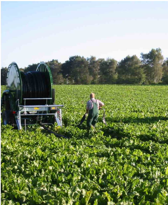
Abb. 8.2: Umstellen einer Regenmaschine (E. Schulz)
