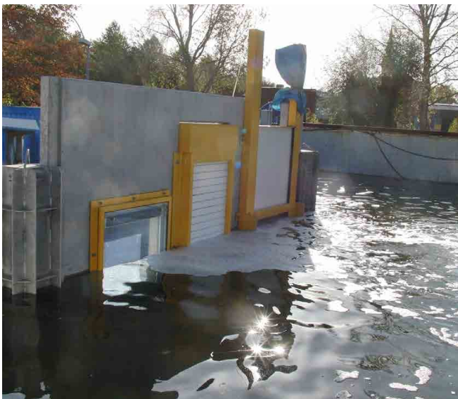
Abb. 5.5.2: Schutzelemente für Tür, Fenster und Kellerfenster während eines Tests im Wasserbecken der TUHH
