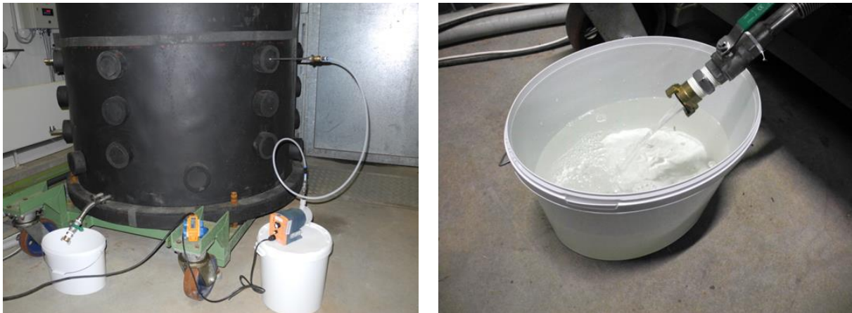
Abbildung 84: Reaktor mit Beregnungslanze, angeschlossener Pumpe und Sickerwasserauslauf.
