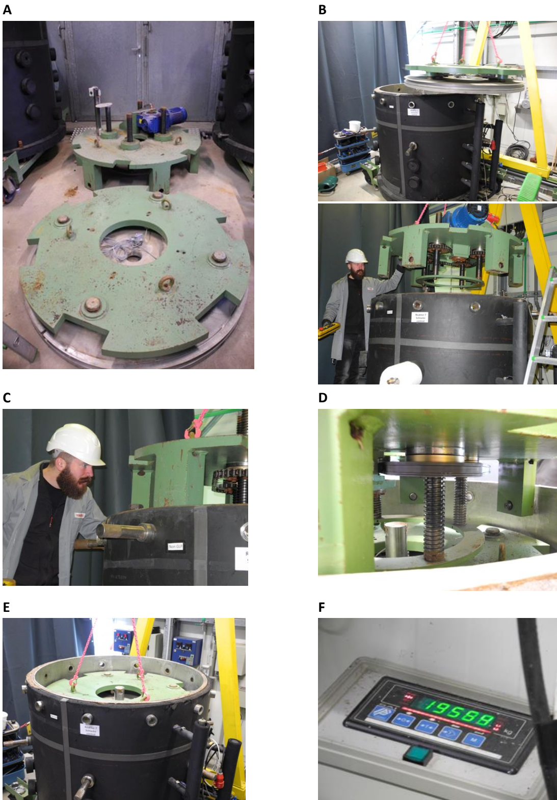
Verschließen des Reaktors (A - E); A: Deckel (vorn) und motorgetriebener Druckplatte (hinten); C: Blick auf die motorgetriebene Spindelplatte mit der der Druck ausgeübt wird; F: Anzeige des ausgeübten Drucks (hier 19.588 t auf die Gesamtoberfläche ( \approx 13 \text{ t/m}^2 )) (eigene Darstellung, Fraunhofer IME).
