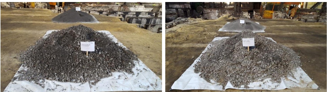
Aufbereitete Schlacke Referenz (links) und aufbereitete Schlacke n\text{TiO}_2 (rechts) gegen Ende der 3-monatigen Lagerung (eigene Darstellung, Fraunhofer UMSICHT)
