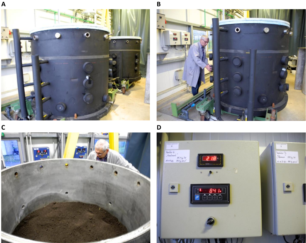
Abbildung 89: Blick in die Reaktorhalle (A+B) und in einen der Reaktoren mit dem Gemisch aus Boden (RefeSol 04-A) und Klärschlammmasche (C) sowie Aufnahmeelement (D) für Gewicht (untere Anzeige) und Temperatur (obere Anzeige).
