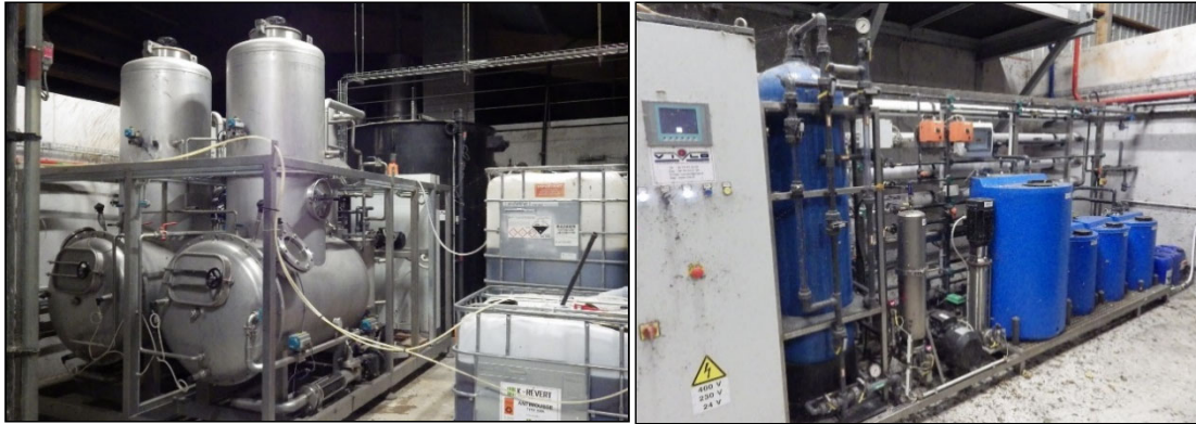
Abbildung 82: Verdampfung und Membranstufe des K-Revert-Prozesses
