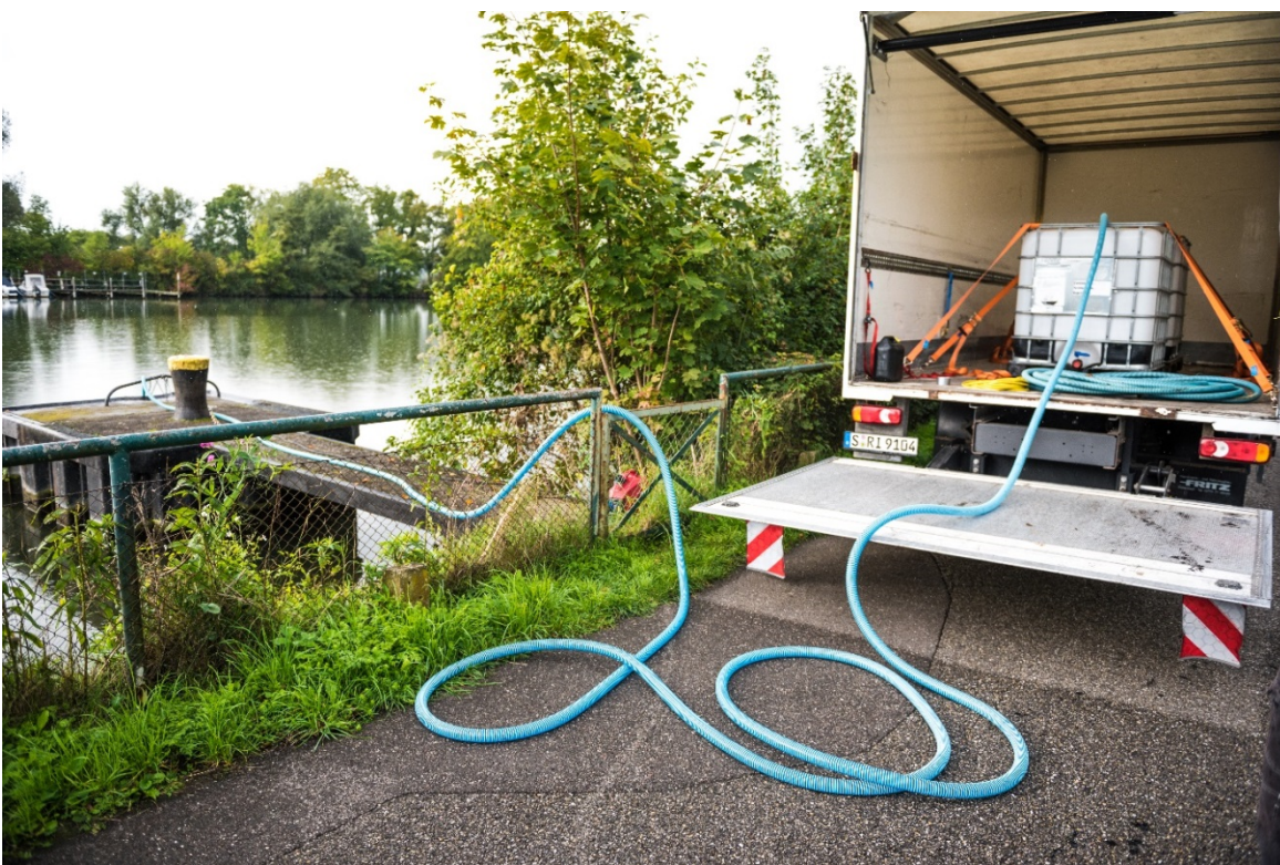
Abbildung 5: Schwebstoffbeprobung des Neckars oberstrom der Kläranlage sowie Stichprobenahme- stelle Schlauchboot.
