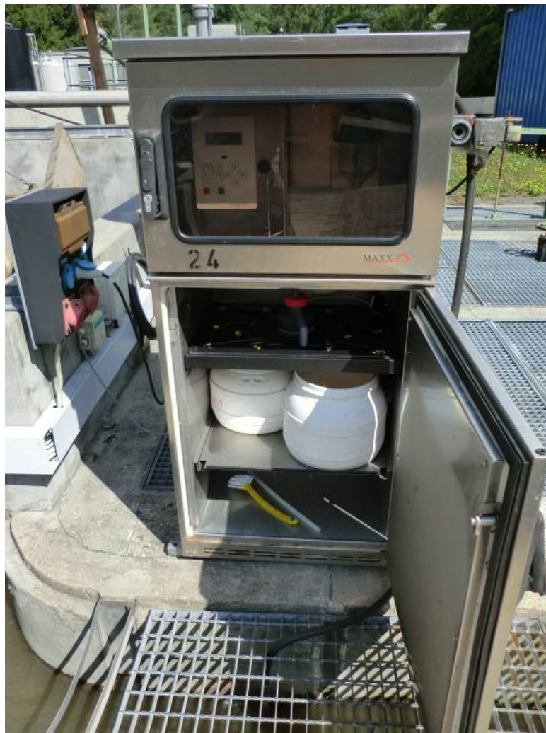
Abbildung 18: Automatischer Probenehmer für durchflussproportionale Probenahme, gekühlt.
