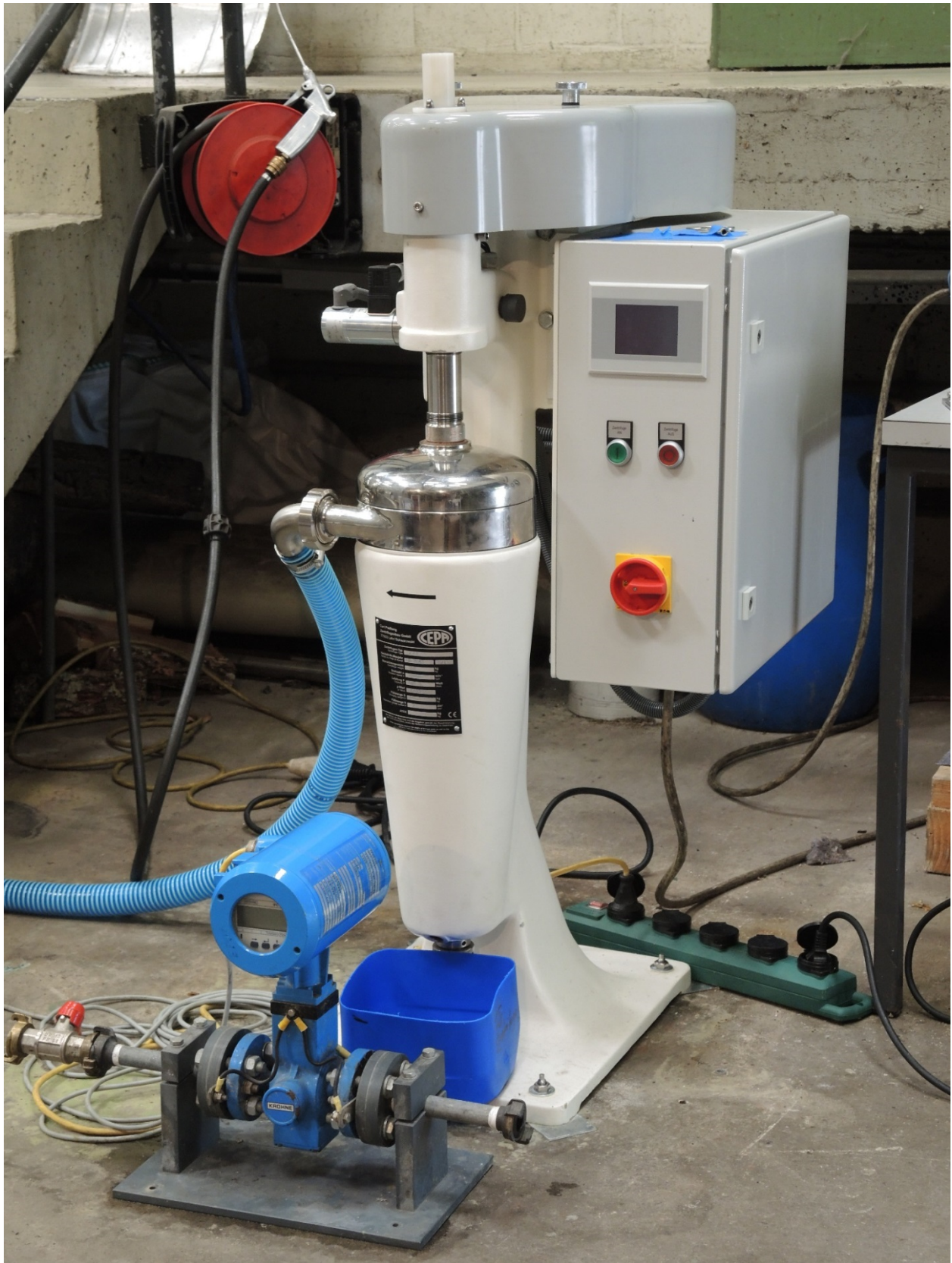
Abbildung 19: Zentrifuge Padberg CEPA Z41 zur Schwebstoffgewinnung.
