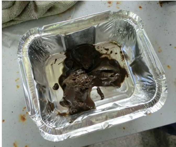
Abbildung 20: Schwebstoffmasse bei 4,5 m 3 Durchsatz eines Baches (ungetrocknet ca. 100 g).
