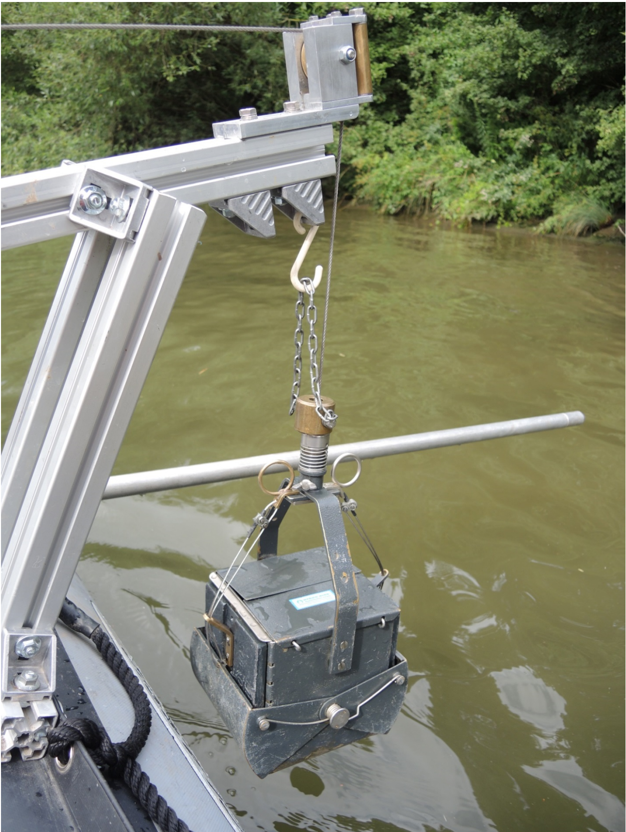
Abbildung 21: Auf Schlauchboot montierter Greifer nach Ekman-Birge bzw. nach Lenz.
