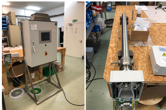
Abbildung 8: Messschrank Amesa M der Envea Deutschland und Messlanze (rechts)
