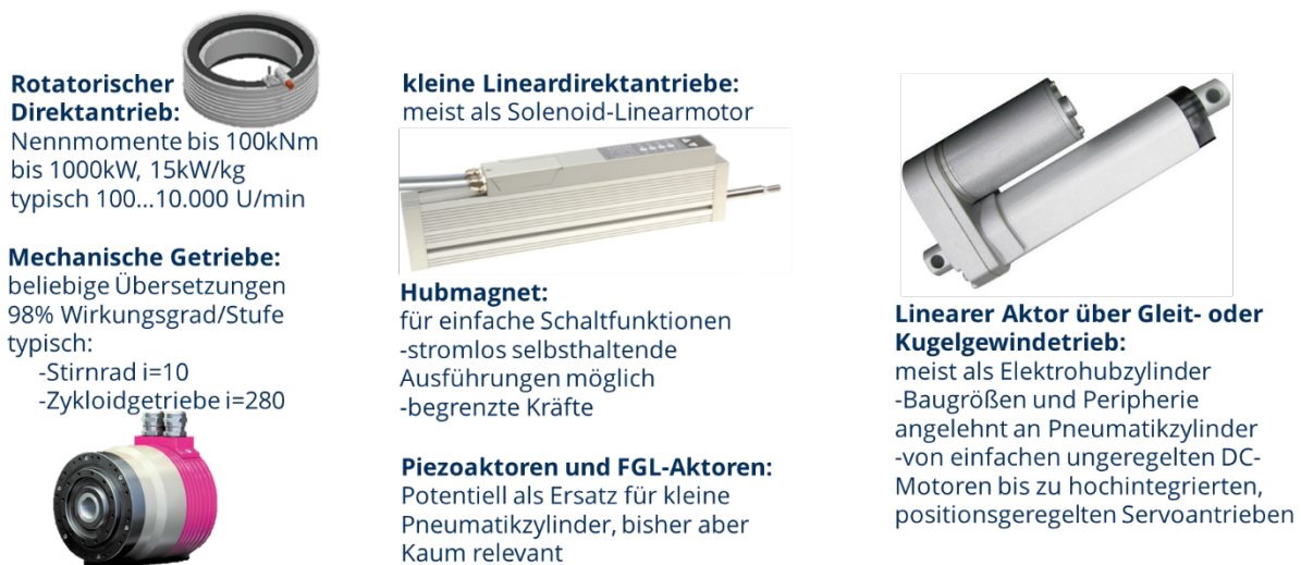
Abbildung 32: Übersicht der Alternativen zu pneumatischen Antrieben
