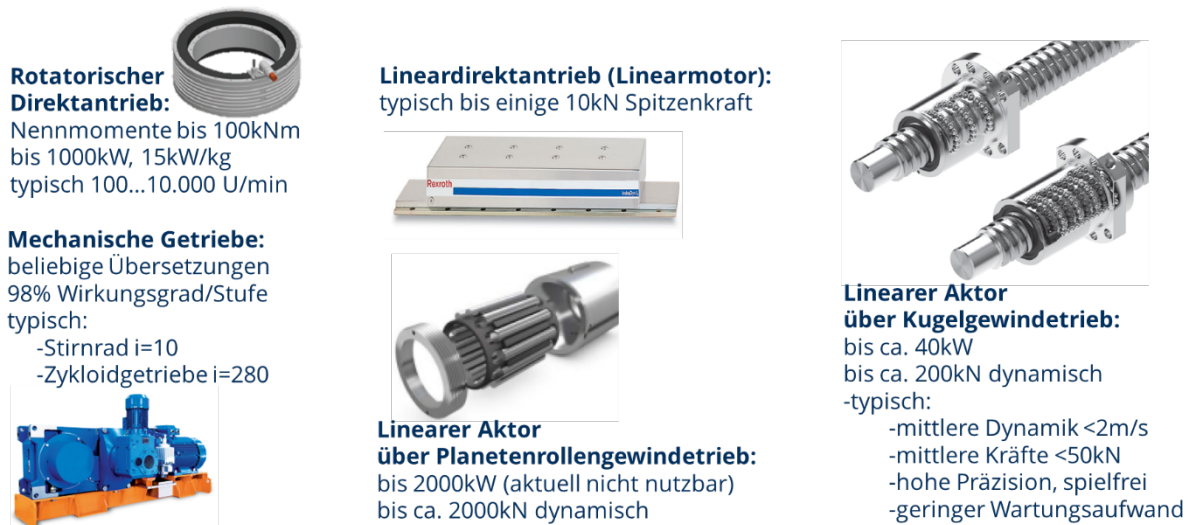
Abbildung 31: Übersicht der Alternativen zu hydraulischen Antrieben
