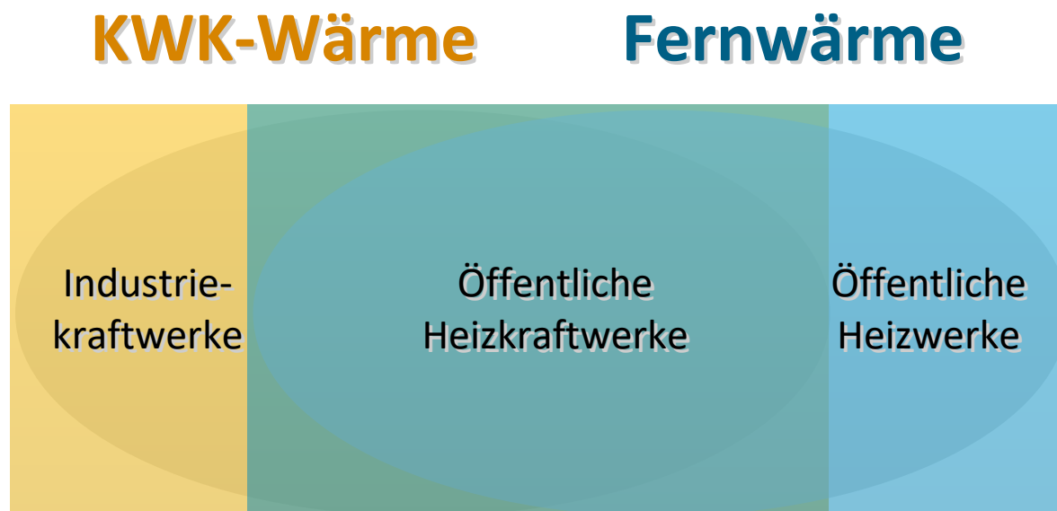
Abbildung 8: Begriffsklärung KWK-Wärme und Fernwärme
