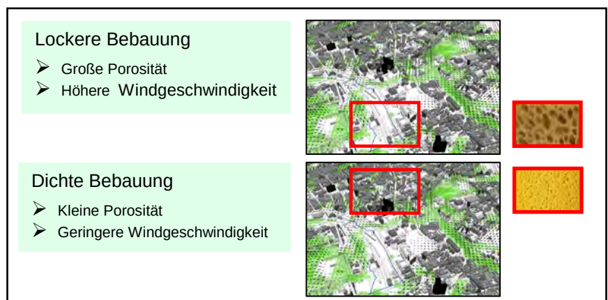
Abb. 5: Einfluss der Bebauungsdichte auf die Strömungsgeschwindigkeit
