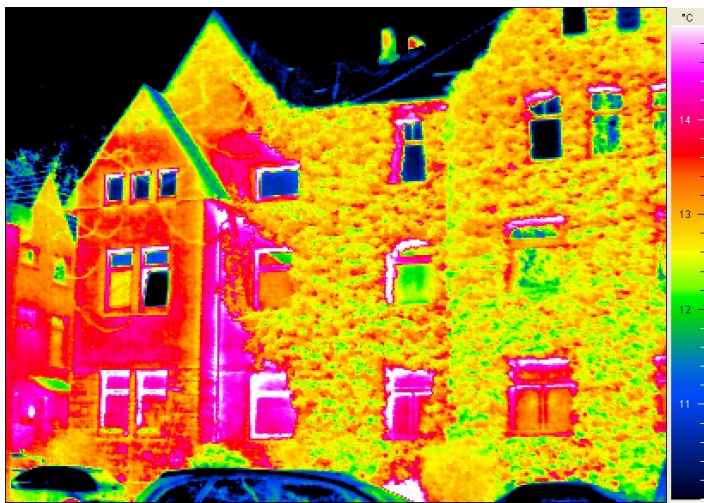
Abb. 5-34 Oberflächentemperaturen einer begrünten (rechts) und unbegrünten Hauswand (Foto: Mersmann)
