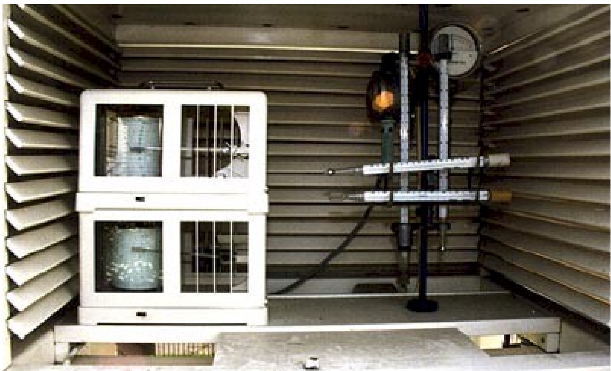
Abb. 2-2 Analoge und digitale Lufttemperaturmessungen an der Bochumer Ludger-Mintrop-Stadtklimastation
