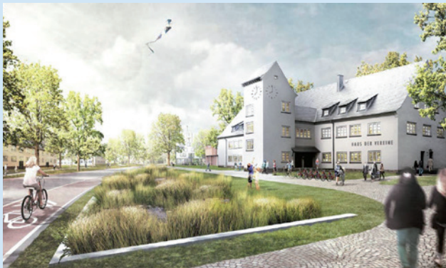
Zentrale Retentions- und Versickerungsmulde
