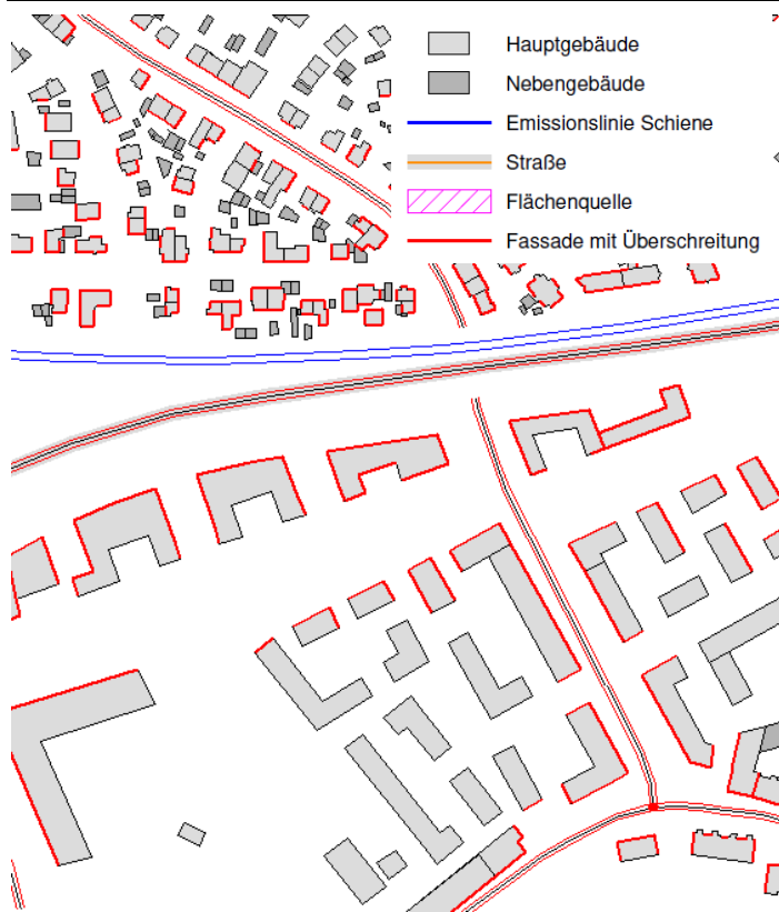
Abbildung 22: Kennzeichnung der Fassaden mit Überschreitungen (Ausschnitt)
