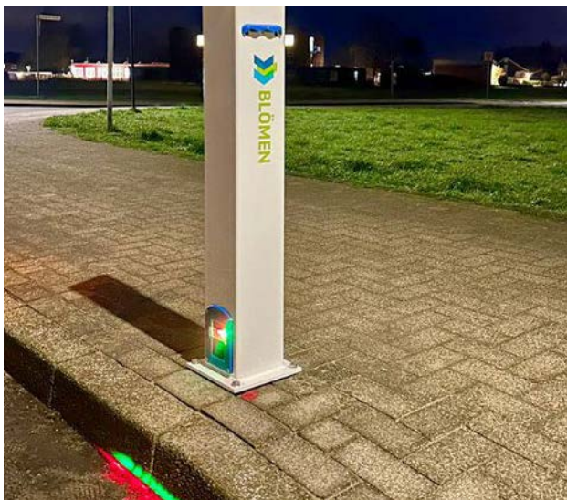
Abbildung 43: Laserstrahlen erzeugen einen Lichtteppich über dem Fußgängerüberweg · Quelle: Blömen VuS
