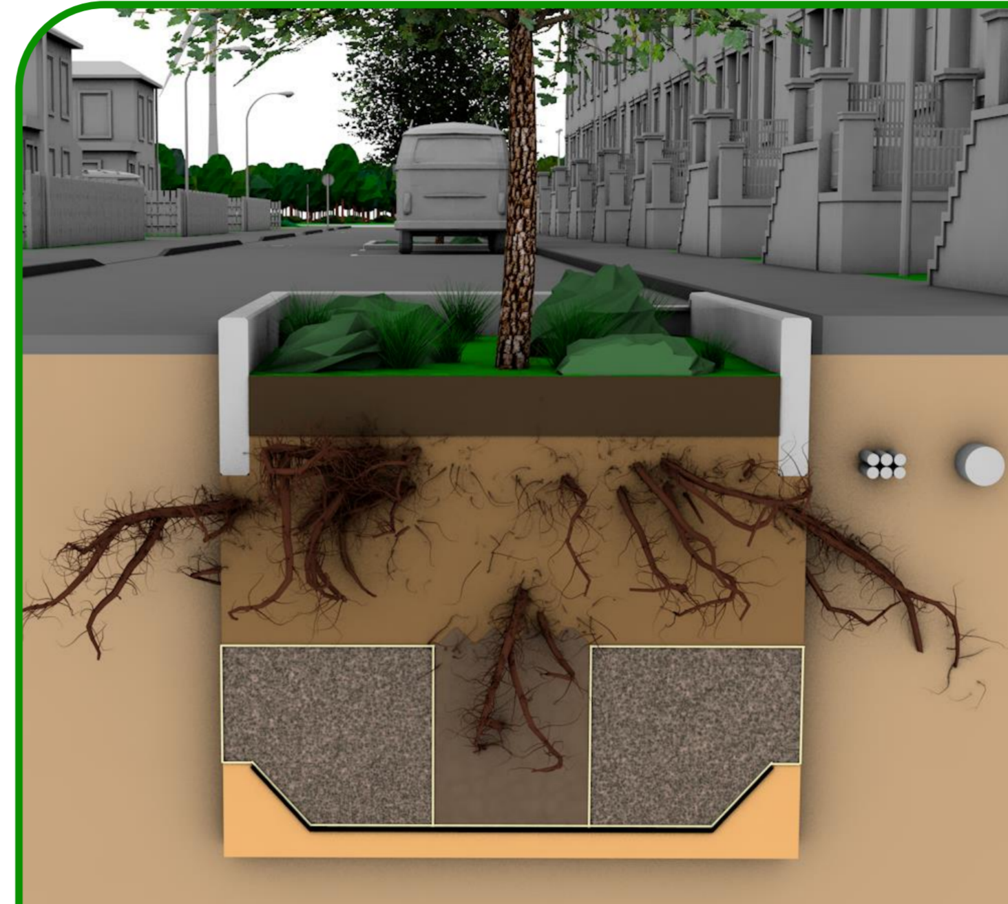
Prinzipaufbau | Baumrigole mit Bodenwanne
