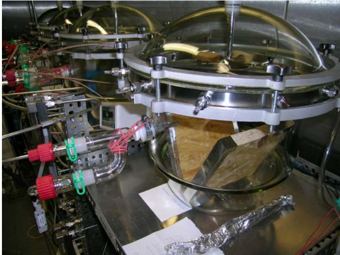
Abbildung 2: OSB-Platte in einer 24-Liter Emissionsprüfkammer
