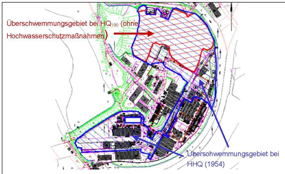
Anhang 6, Abb. 8: Überflutetes Werksgelände bei HHQ
