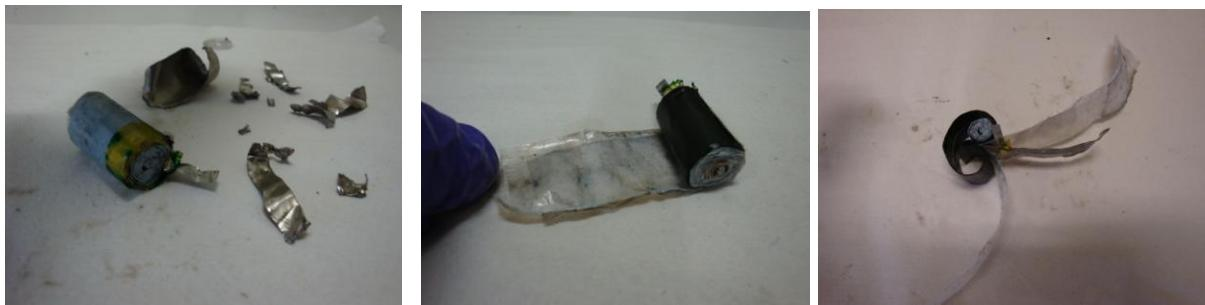
Separatormembran, Metallträger (Netz oder Folie) inkl. Kathodenmaterial und Lithium voneinander trennen. Das Kathodenmaterial vom Träger abschaben, Reste mit Wasser entfernen. Die einzelnen Bestandteile wiegen, die Gewichtsermittlung des Kathodenmaterials erfolgt durch Differenzwägung.
