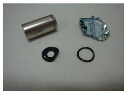
Die Wickelzelle aus dem Stahlbecher entnehmen und vorsichtig entrollen.
