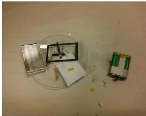
möglichst ohne die innenliegende Wickelzelle zu beschädigen. Die Wickelzelle entfernen, ihre Einzelteile separieren und wiegen. Die Alufolie mit dem Anodenmaterial sowie die
