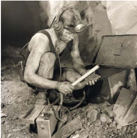
Abb. 2: Hauer im Abbau bei der radiometrischen Erzsartierung, ca. 1960 (Wismut GmbH)
