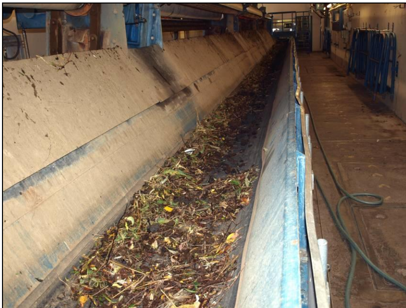
Abb. 5.40: Das am Feinrechen anfallende Treibgut wird separat von der Rechenreinigungsanlage auf ein Förderband geworfen, über das es einer Schredder- anlage zugeführt wird; hier können im Rechengut enthaltene Fische abgesammelt werden
