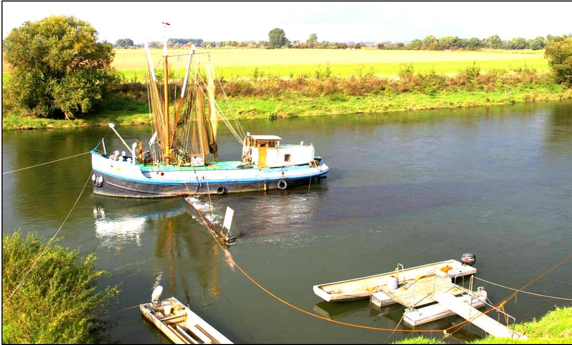
Abb. 5.12: Schokker des Fischereibetriebs Gebr. Dobberschütz (Seitenansicht); der Hamen erstreckt sich als dunkler Schatten von seitlich neben bis weit hinter dem Rumpf
