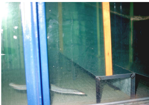
Abb. A.6: Eine gegen die Strömungsrichtung geöffnete Schwelle („Bottom Gallery®“), die die Aale zu einem seitlichen Bypass leitet (oben Gesamtansicht; unten Detail) EUROPÄISCHES PATENT DER ARBEITSGEMEINSCHAFT GEWÄSSERSANIERUNG (ADAM et al. 2002).
