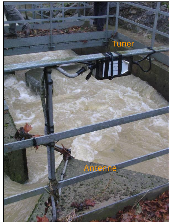
Abb. 5.81: Eher provisorisch installierter Tuner und HDX-Antenne an einem Durchlass des Fischpasses am Wasserkraftwerk Castetarbe am Gave de Pau (Frankreich)
