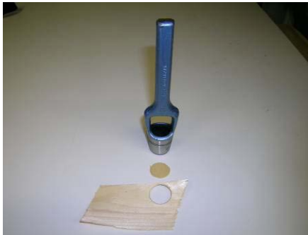
Abbildung 8: Aus einem Strand ausgestanzter Prüfkörper (22 mm) für Untersuchungen in der Micro-Chamber
