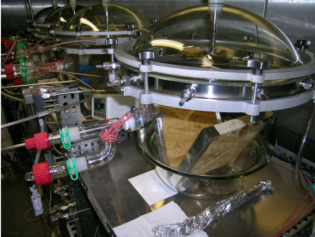
Abbildung 9: OSB-Platte in 24-l-Emissionsprüfkammer
