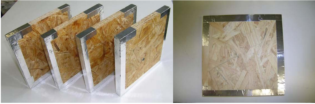
Abbildung 6: Abgeklebte Prüfkörper (9,6 cm offene Schmalfläche)
