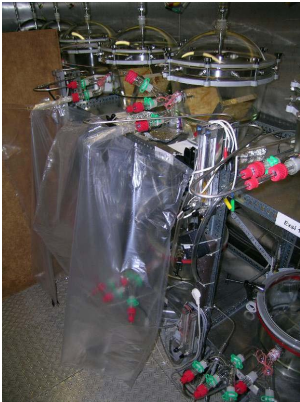
Abbildung 13: Anschluss der Tedlar-Behälter an die 23-l-Kammer
