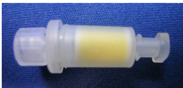
Abbildung 12: DNPH-Probenahme-Kartusche für Aldehyde und Ketone
