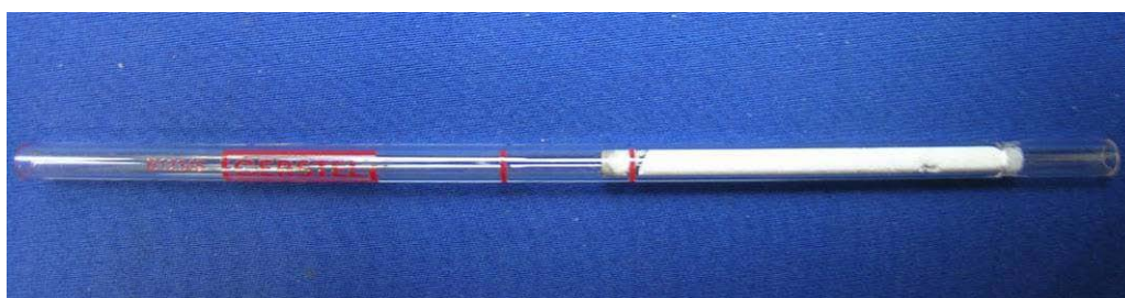
Abbildung 11: Tenax-Röhrchen für die Luftprobenahme
