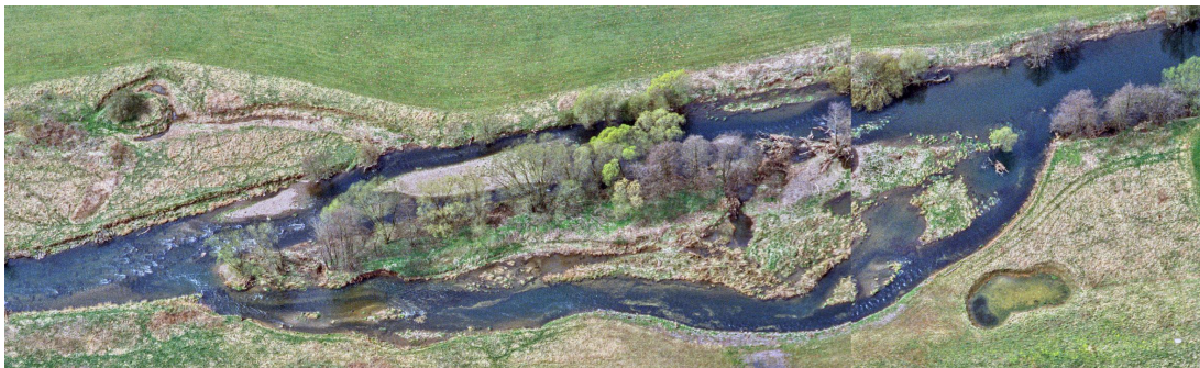
Abb. A.2: Gewässertypgerechte Entwicklung eines Standortes an der oberen Lahn (Hessen): die ursprünglich vorhandenen Furkationen stellen sich wieder ein und bilden durchwanderbare Gewässerarme mit natürlichem Sohlengefälle. Die Gewässerarme sind gegenüber Fischaufstiegsanlagen, die das Gefälle lokal konzentrieren, weniger wartungsintensiv und ökologisch hochwertiger.
