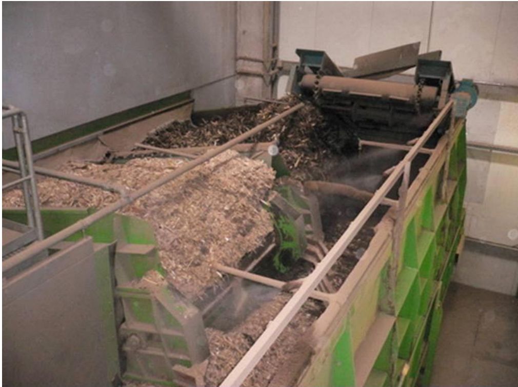
Abb. 80 Mischung von Waldholz (links) mit aufbereiteten Holzigen Grünabfällen (rechts) zur thermischen Nutzung in einem Holzheizkraftwerk
