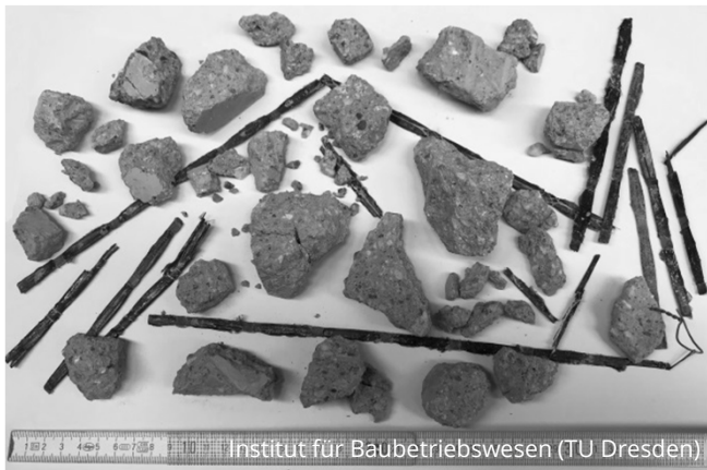
Bruchmaterial Größe 0/56, vollständiger Aufschluss
