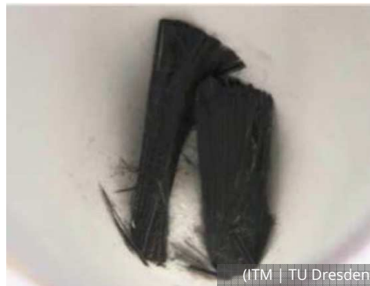
Einzelprobe nach der Pyrolyse bei 550°C
