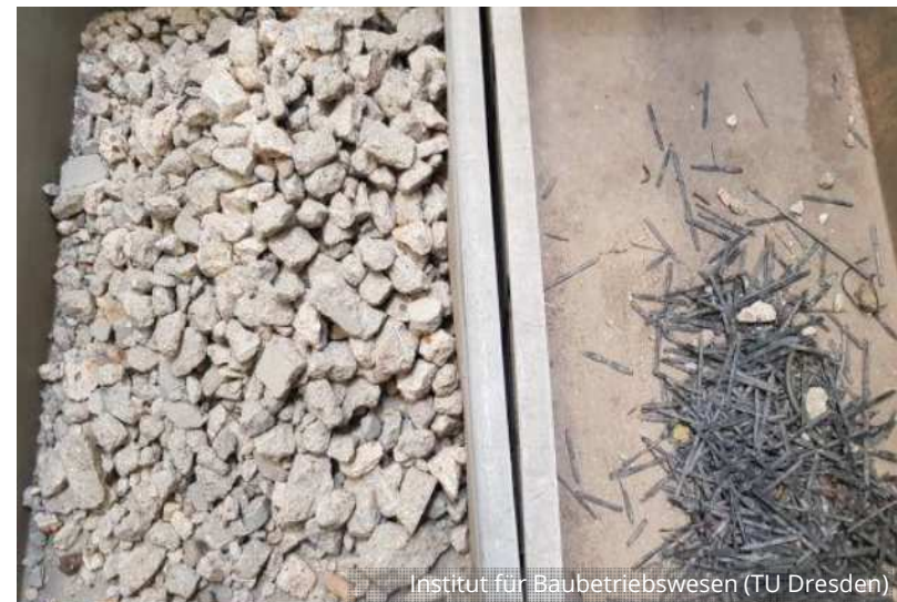
Nahezu sortenreines Outputmaterial Beton 0/56 und Carbonbewehrung
