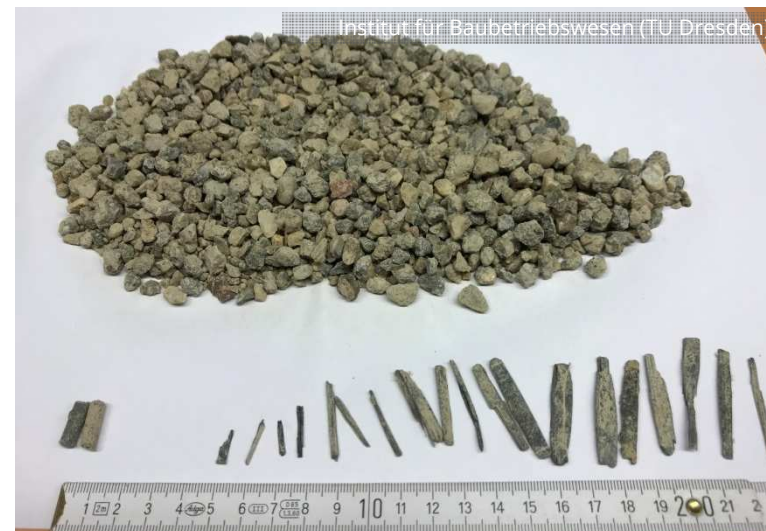
Manuell separierte Carbonfasern
