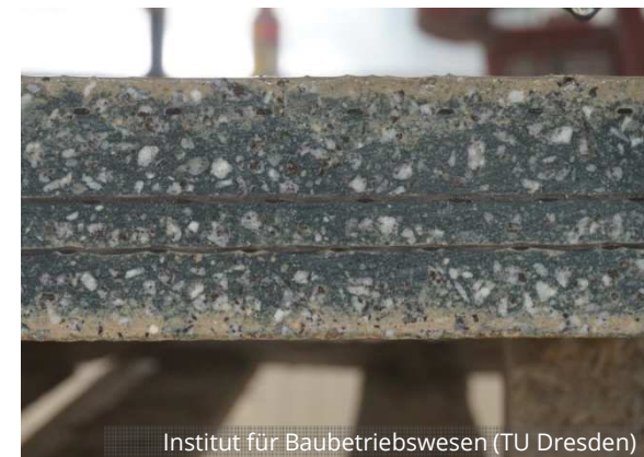
Schnittbild an einer hochfesten C 3 - Platte inkl. Bewehrungsverlauf
