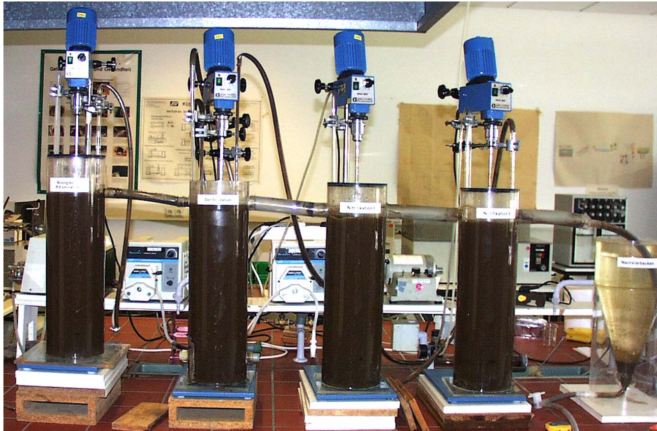
Versuchsaufbau der Laborkläranlage
