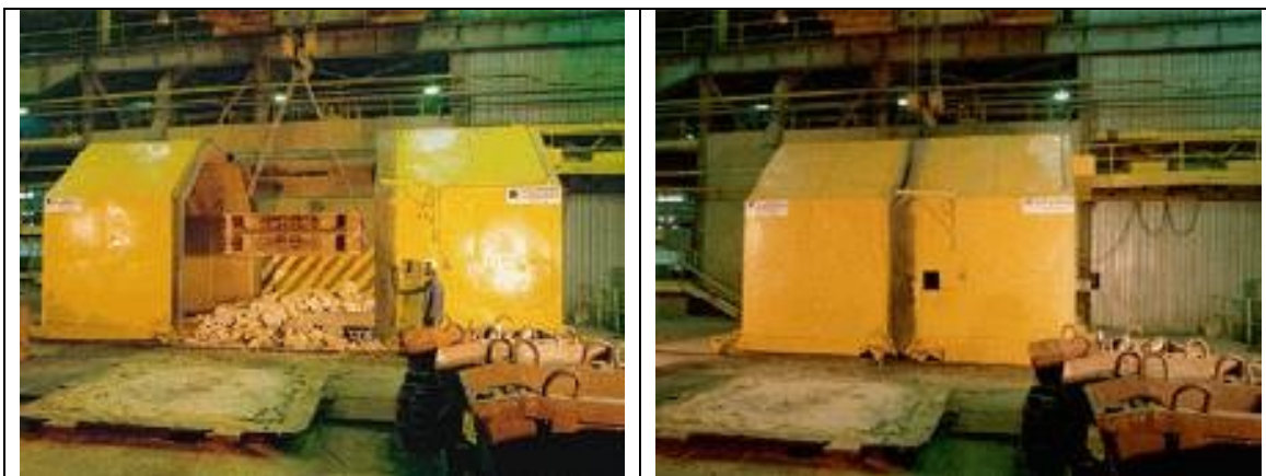
Bild 4.17: Einhausung für ein Ausschlagrost für große Einzelgussteile [209, Metalodlew s.a., 2003]
