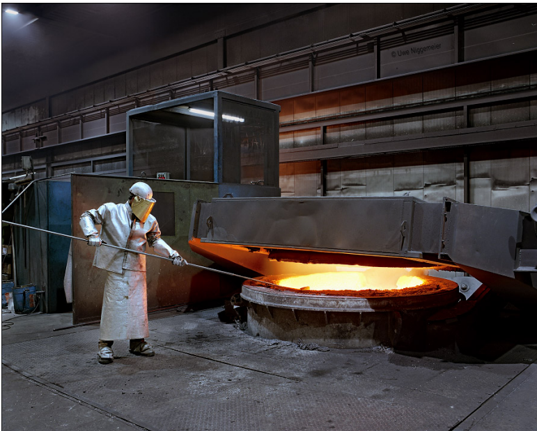
Abbildung 23: Mittelfrequenz Induktionstiegelofen mit Stauberfassung in der Eisengießerei Siempelkamp, Krefeld
