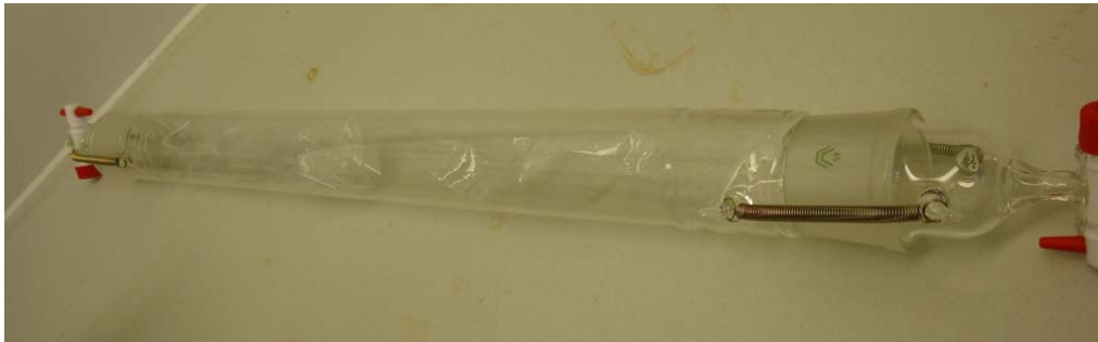
Abbildung A-3.20: Glasrohr zur Trocknung der LDPE-Schlauchstücke. An einem Ende ist die Stickstoffzufuhr angeschlossen, das andere Ende ist offen für die Abluft. Foto: UFZ
