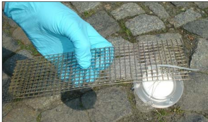
Abbildung A-3.2: MESCO Gitter mit Chemcatcher (2. Generation). Foto: UFZ
