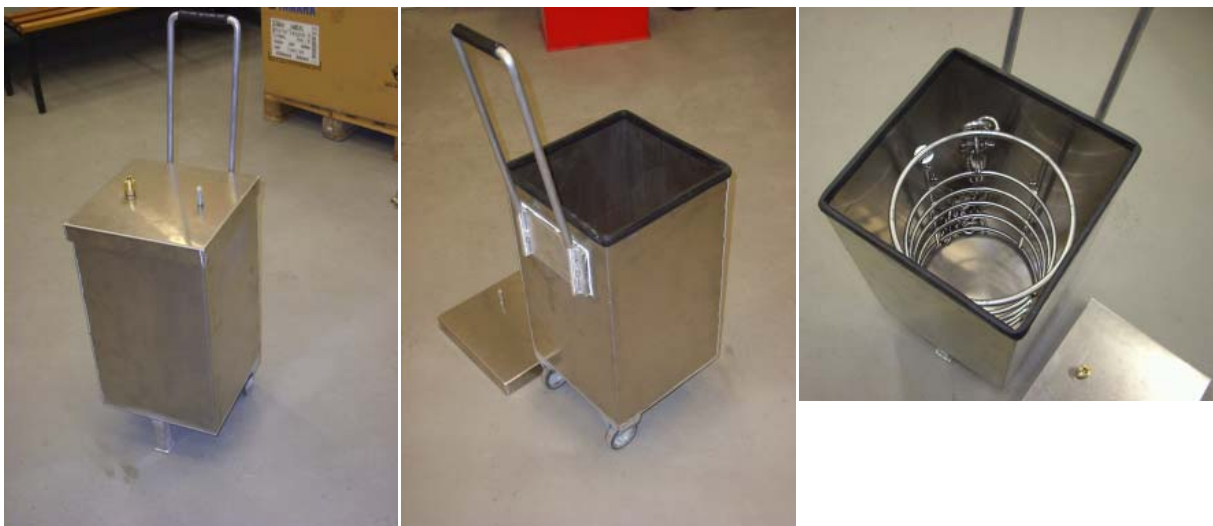
Abbildung A-3.16: Gasdichter Transportbehälter für Passivsammlerkorb (Prototyp), der den Transport eines bereits bestückten Sammler-Korbes unter Schutzatmosphäre erlaubt. Fotos: Pohle, BSH
