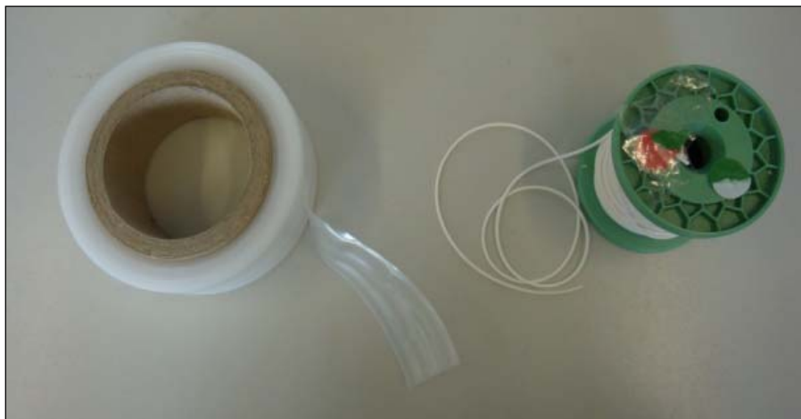
Abbildung A-3.8: Rohmaterial LDPE-Schlauch (links) und Silikonstab (rechts). Foto: UFZ
