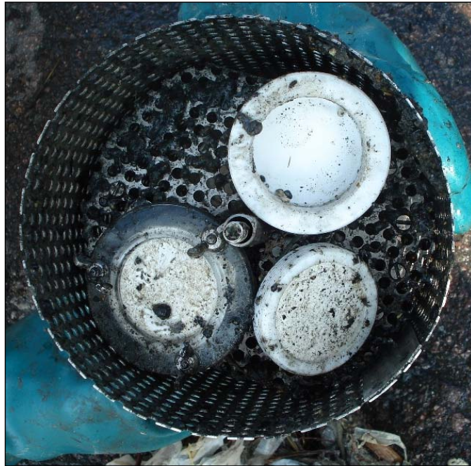
Abbildung A-3.4: Chemcatcher in SPMD-Käfig. Foto: UFZ
