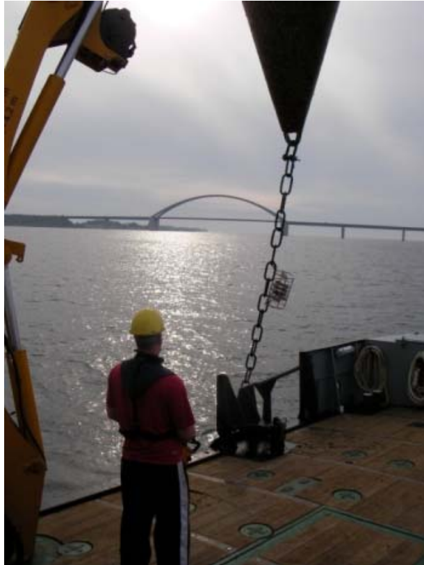
Abbildung A-3.13: Heben der Seezeichentonne Fehmarnsund 3 mit Kette und Ankerstein mittels Kran zur Einholung des Sammelkorbs. Fotos: Kraus, BSH
