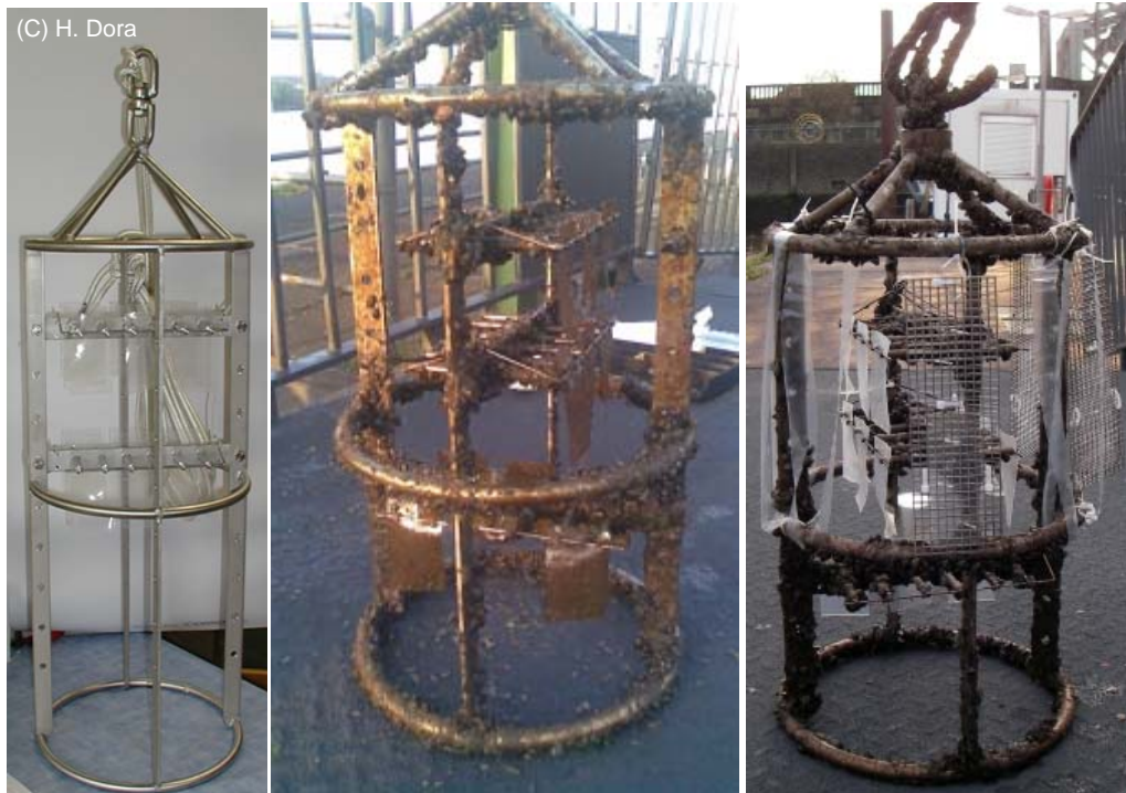
Abbildung A-3.17: Edelstahlkorb nach Vorbild der Arbeitsgruppe von F. Smedes (National Institute for Coastal and Marine Management, Netherlands bzw. Deltares Geo-environmental Research Laboratory, Utrecht). Links und Mitte: Bestückung ausschließlich mit Silikonsammlern, rechts: Bestückung mit verschiedenen Sammlertypen. Fotos: links: Dora, BSH; Mitte und rechts: Kraus, BSH
