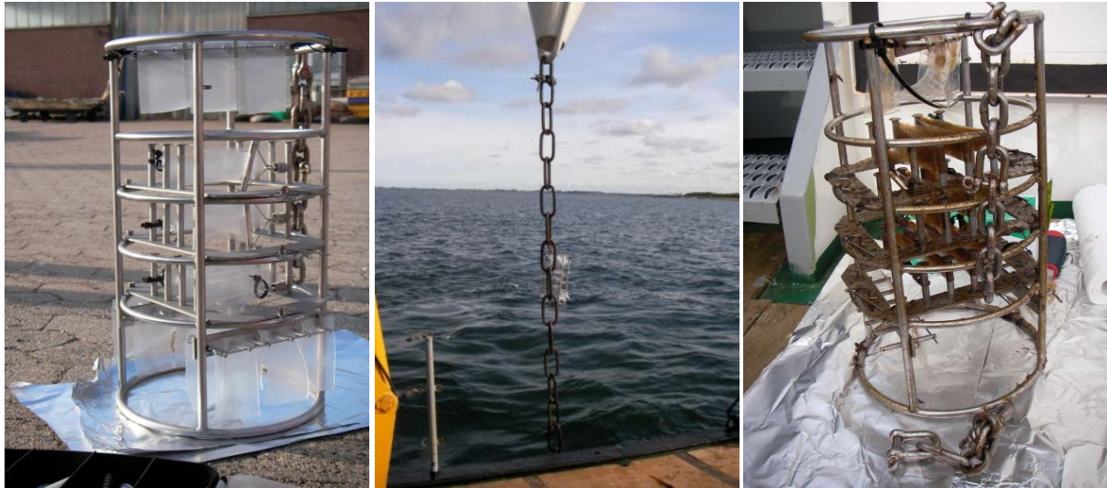
Abbildung 7: Bestückter modularer Sammlerkorb aus Edelstahl, Ostsee-Design, vor, während und nach Ausbringung. Fotos: Kraus, BSH
