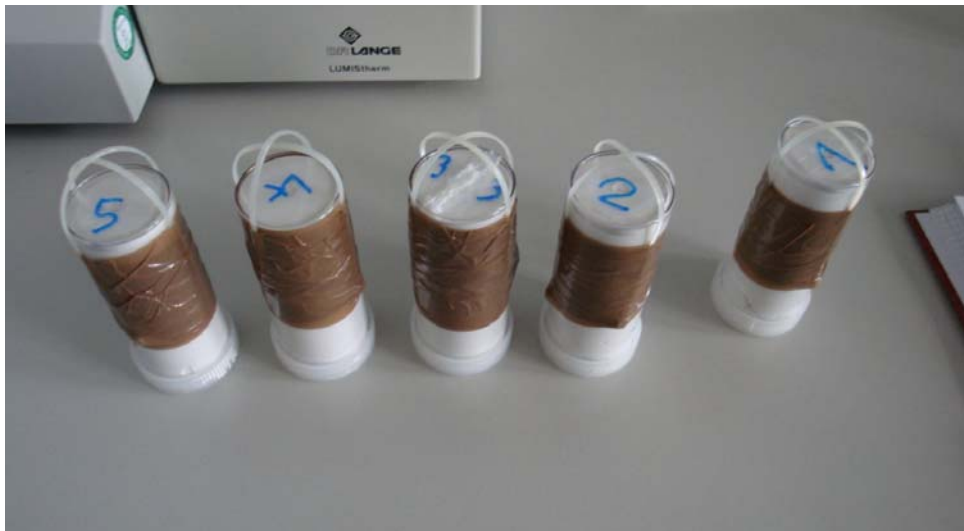
Abbildung A-3.18: Gipskartuschen zur Ermittlung der durchschnittlichen Fließgeschwindigkeit vor dem Ausbringen. Foto: UFZ
