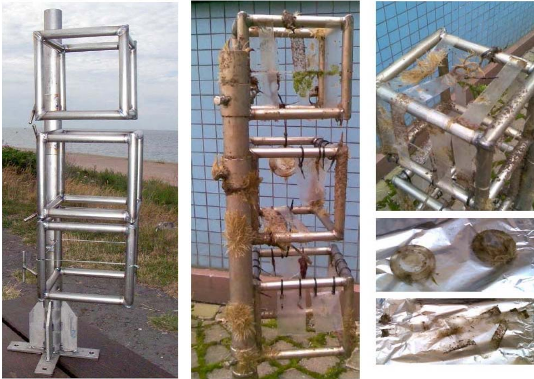
Abbildung A-3.15: Prototyp eines hochseetauglichen Sammlerkorbs vor und nach Strömungstests vor Helgoland. Foto: Kraus, BSH
