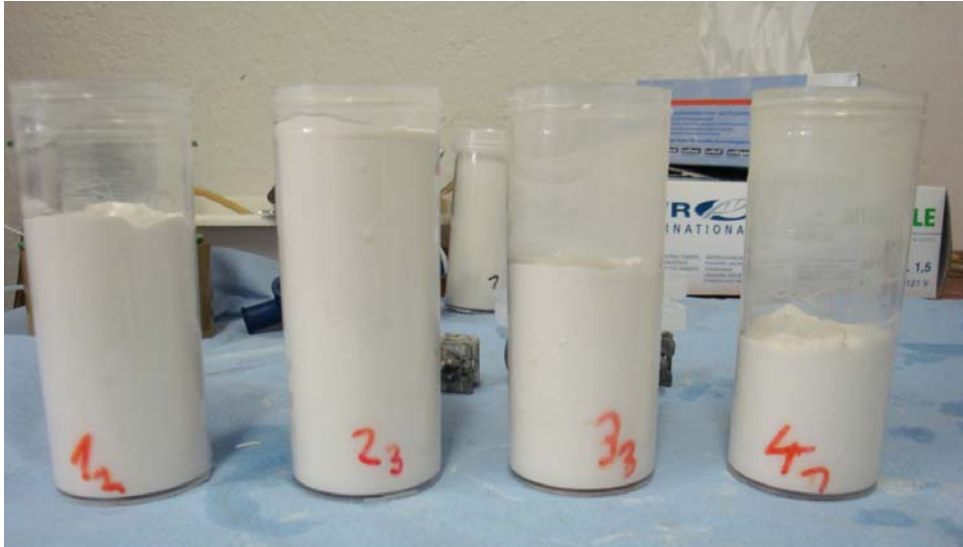
Abbildung A-3.19: Gipskartuschen nach der Verwendung (im Laborversuch). Foto: UFZ
