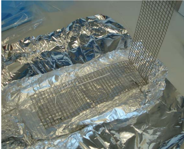
Abbildung A-3.6: Geöffnetes Gitter mit MESCO und Silikonstab. Foto: UFZ
