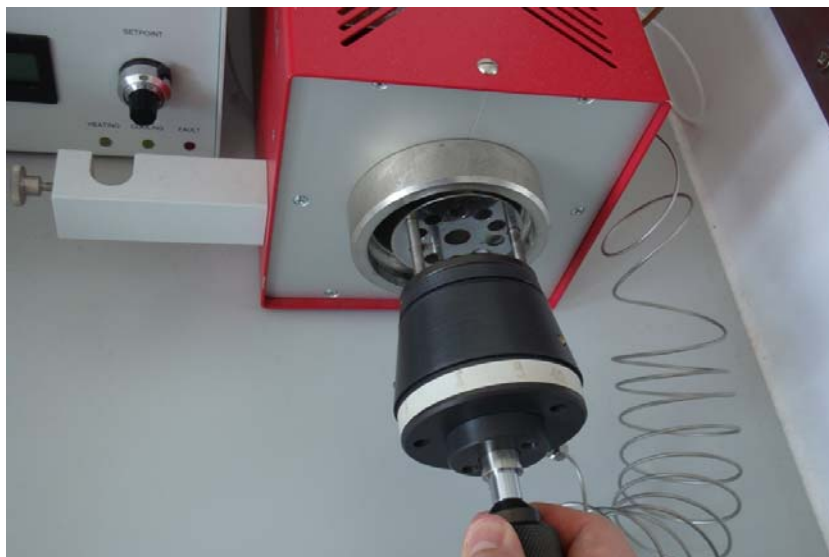
Abbildung A-3.21: Konditionierofen von Gerstel zum Ausheizen von Twister® und Silikonstäben für MESCO und Silikonstab-Sammler. Foto: UFZ
