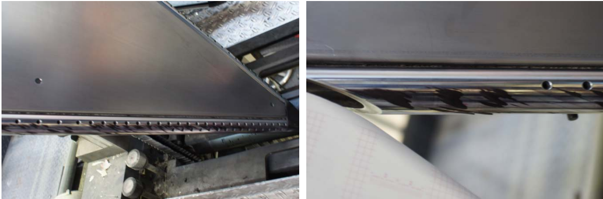
Abb. 10: Rückstände am Falztrichter nach dem Druckvorgang mit dem mineralölfreien Farbsatz 3 MöF.
