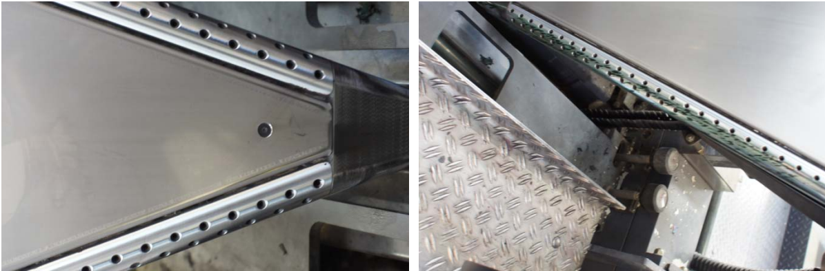
Abb. 8: Rückstände am Falztrichter nach dem Druckvorgang mit dem mineralölhaltigen Farbsatz 1.
