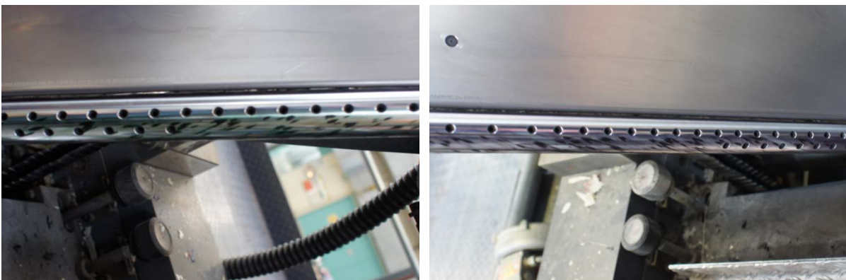
Abb. 9: Rückstände am Falztrichter nach dem Druckvorgang mit dem mineralölfreien Farbsatz 2 MöF.
