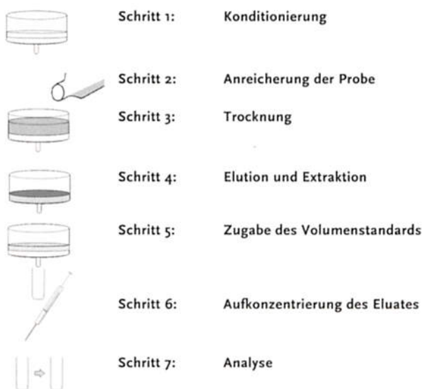
Bild 2: Schematische Darstellung des SPE-Probenbereitungsverfahrens mittels SPE-Disk
